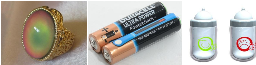
Slika 1. Primjena termokromnih materijala. 3,4,5
