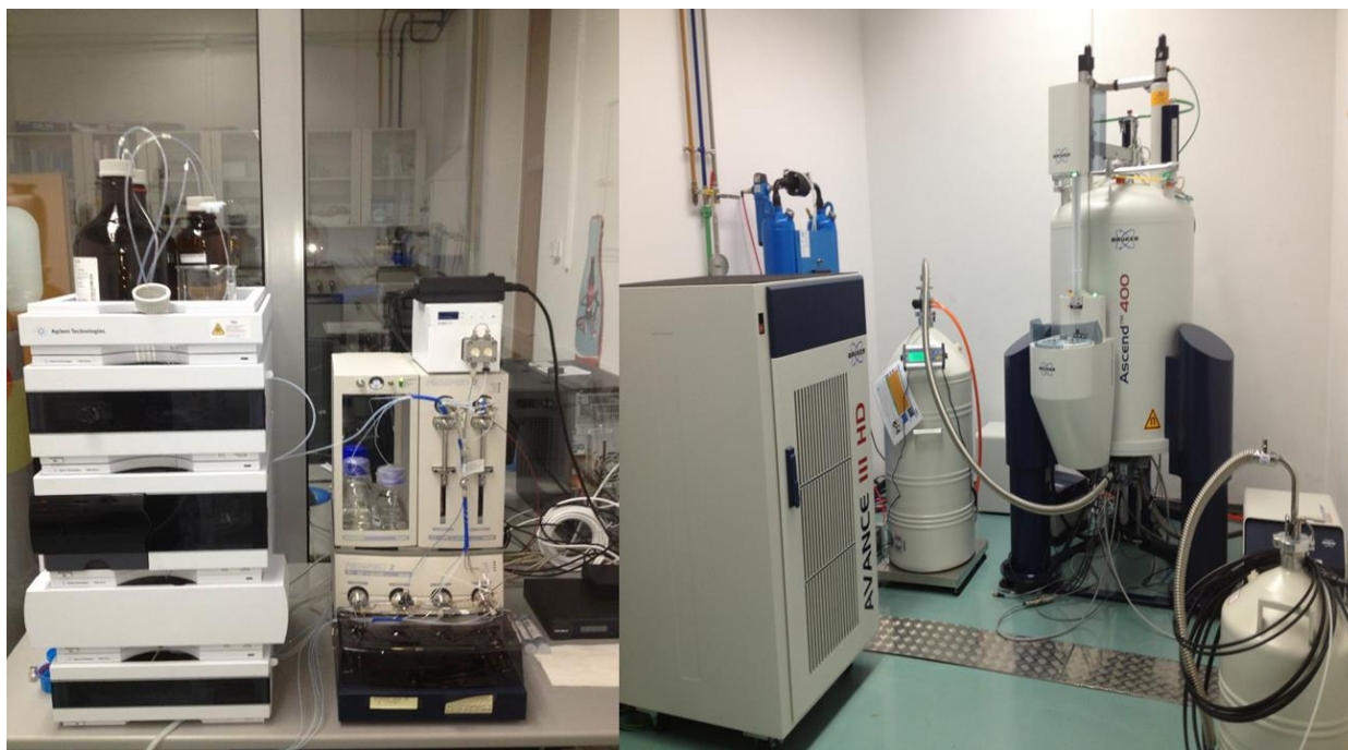
Slika 2.7.1. Vezani sustav LC-SPE/krioNMR.
