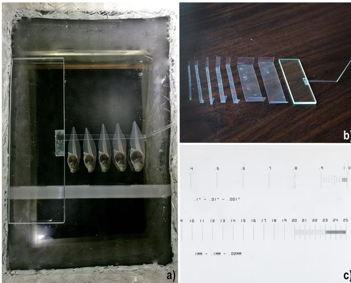
Slika 6. Prikaz procesa skeniranja punoglavaca pomoću Epson Perfection V600 Photo skenera a) kadica sa postavljenim punoglavcima, b) izgled pomoćnih dodataka korištenih za fiksiranje punoglavaca i mikroskopsko stakalce sa mjerkom, c) izgled dijela mjerke mikroskopskog stakalca nakon skeniranja
