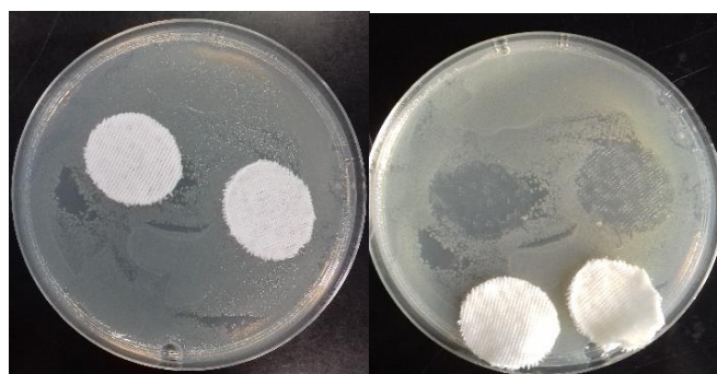
Slika 24. Uzorak sirove viskoze bez zone inhibicije (lijevo) i neznatnim rastom ispod uzorka (desno) za bakteriju E. coli
