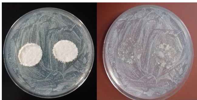
Slika 19. Uzorak pamuka bez zone inhibicije (lijevo) i jakim rastom ispod uzorka (desno) za bakteriju S. aureus
