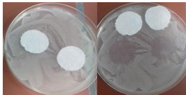
Slika 18. Uzorak sirove viskoze bez zone inhibicije (lijevo) i slabim rastom ispod uzorka (desno) za bakteriju S. aureus
