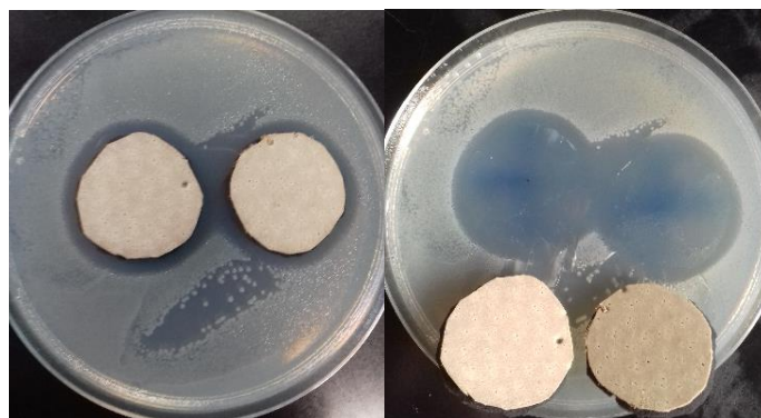
Slika 23. Uzorak antibakterijskog uloška s zonom inhibicije (lijevo) i odsutnim rastom ispod uzorka (desno) za bakteriju E. coli
