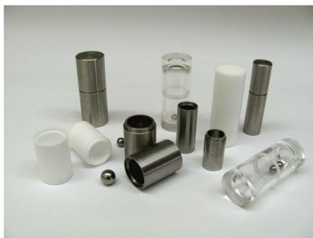
Slika 16. Razne reakcijske posude za mehanokemijsku sintezu
