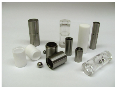
Slika 16. Razne reakcijske posude za mehanokemijsku sintezu
