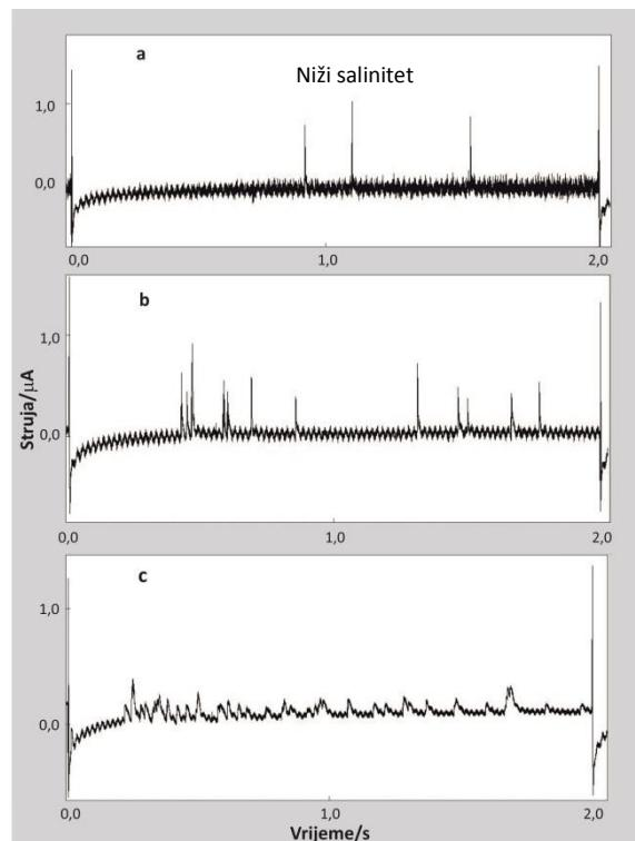
**Slika 18.** Uzastopne krivulje  $I-t$  snimljene bez prisutnosti kisika u suspenzijama stanica *D. tertiolecta*: a)  $7,0 \times 10^3 / \text{mL}$ , b)  $3,5 \times 10^4 / \text{mL}$ , c)  $7,0 \times 10^5 / \text{mL}$  u  $0,1 \text{ mol dm}^{-3}$  NaCl kod potencijala -400 mV.
