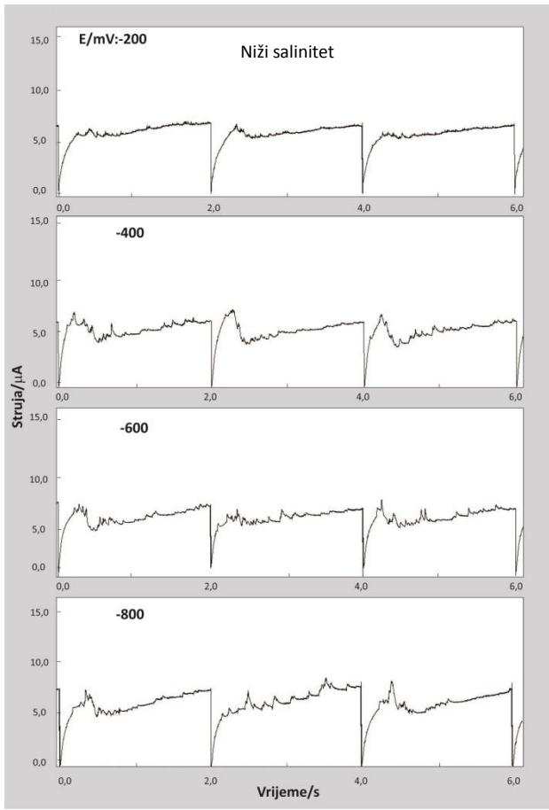
**Slika 14.** Uzastopne krvilje  $I-t$  snimljene u prisutnosti kisika u suspenziji stanica  $D. tertiolecta$   $9,0 \times 10^5/\text{mL}$  u  $0,1 \text{ mol dm}^{-3}$  NaCl kod različitih potencijala.
