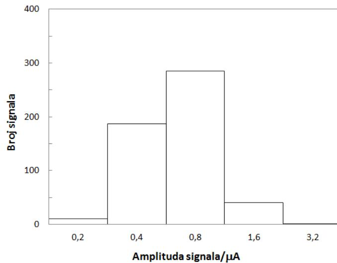
**Slika 19.** Ovisnost broja signala prianjanja stanica *D. tertiolecta*  $2,3 \times 10^5/\text{mL}$  o amplitudi signala snimljeno kod potencijala  $-400\text{ mV}$  u uvjetima bez prisutnosti kisika.
