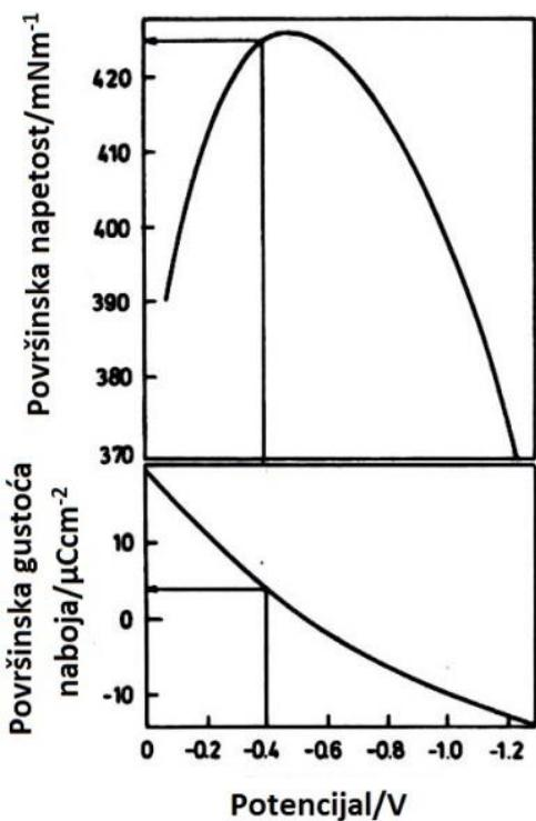
**Slika 5.** Ovisnost površinske napetosti i površinske gustoće naboja o potencijalu na međupovršini živa/0,1 mol dm<sup>-3</sup> NaCl.
