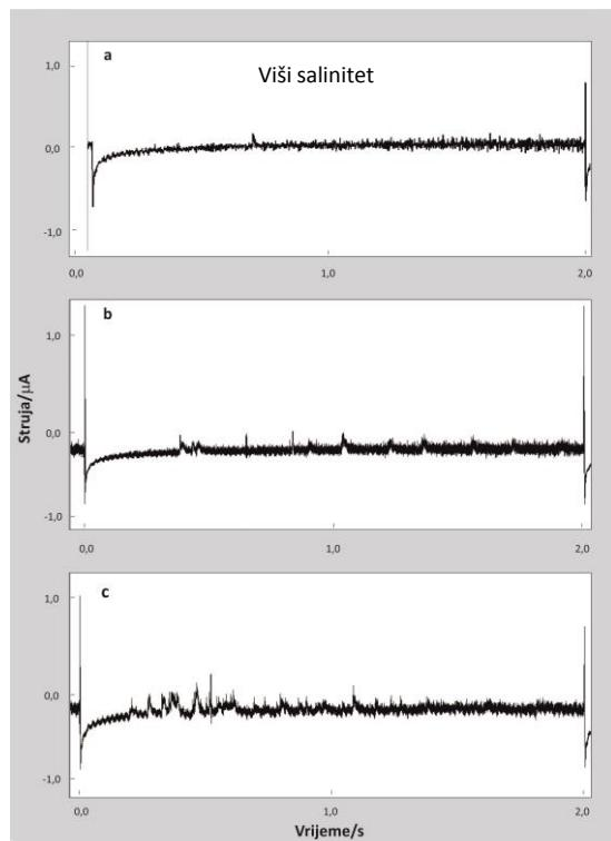
**Slika 17.** Uzastopne krivulje  $I-t$  snimljene bez prisutnosti kisika u suspenzijama stanica *D. tertiolecta*: a)  $2,3 \times 10^4 / \text{mL}$ , b)  $2,3 \times 10^5 / \text{mL}$ , c)  $2,3 \times 10^6 / \text{mL}$  u  $0,1 \text{ mol dm}^{-3}$  NaCl kod potencijala -400 mV.
