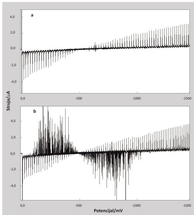
**Slika 16.** Krivulje struje nabijanja živine površine u (a)  $0,1 \text{ mol dm}^{-3}$  NaCl, (b) suspenziji stanica *D. tertiolecta*  $1 \times 10^6/\text{mL}$ .
