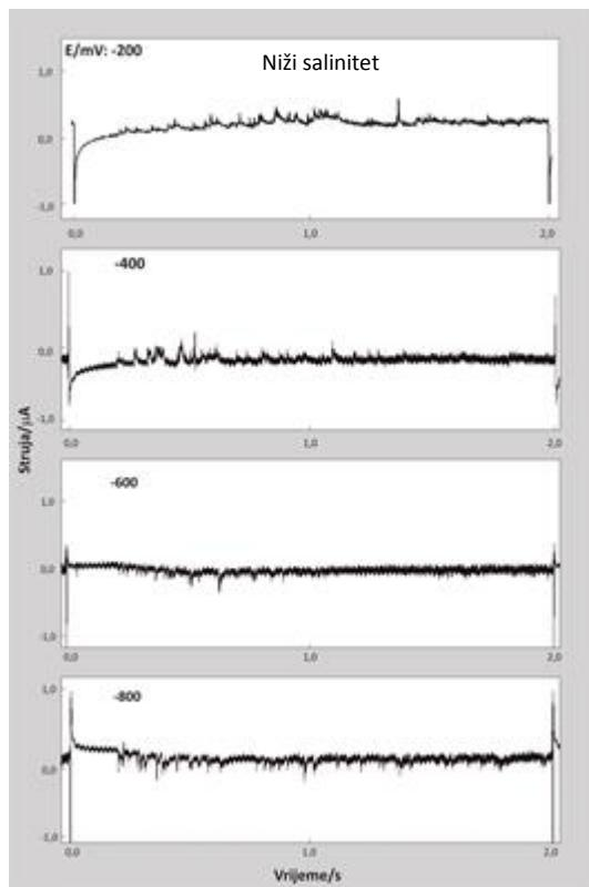
**Slika 21.** Uzastopne krivulje  $I-t$  snimljene bez prisutnosti kisika u suspenziji stanica  $D. tertiolecta$   $7,0 \times 10^5/\text{mL}$  u  $0,1 \text{ mol dm}^{-3}$  NaCl kod različitih potencijala.
