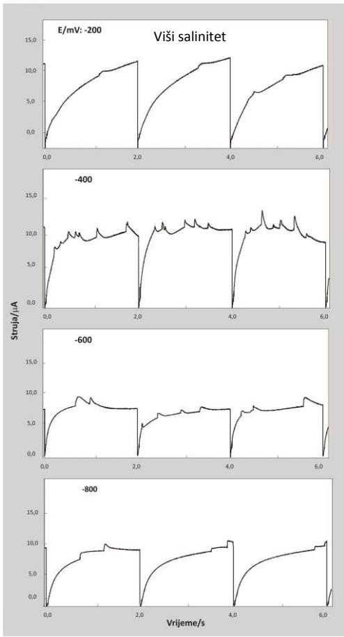
**Slika 13.** Uzastopne krvilje  $I-t$  snimljene u prisutnosti kisika u suspenziji stanica  $D. tertiolecta$   $2,3 \times 10^5/\text{mL}$  u  $0,1 \text{ mol dm}^{-3}$  NaCl kod različitih potencijala.
