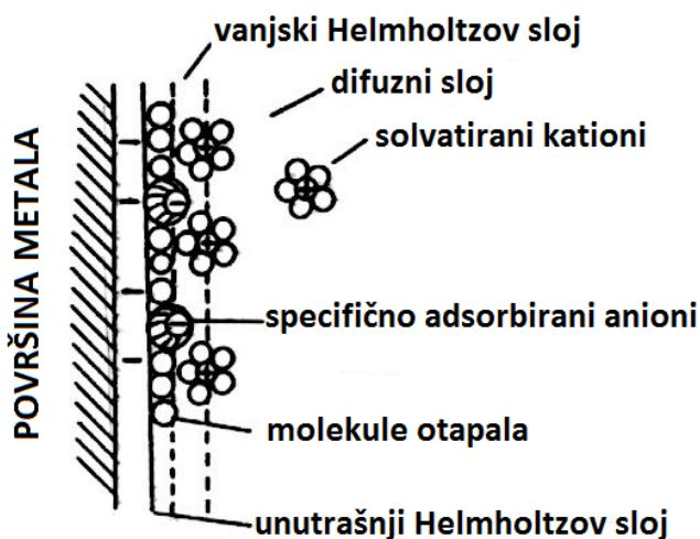
**Slika 4.** Shematski prikaz strukture električnog dvosloja u prisutnosti specifične adsorpcije aniona (preuzeto iz: Bard, Faulkner, 1980).<sup>40</sup>
