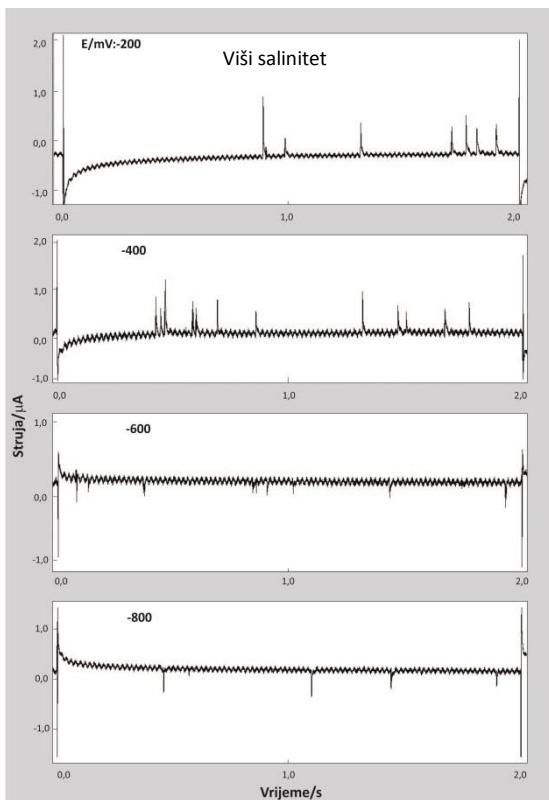
**Slika 20.** Uzastopne krivulje  $I-t$  snimljene bez prisutnosti kisika u suspenziji stanica  $D. tertiolecta$   $2,3 \times 10^5/\text{mL}$  u  $0,1 \text{ mol dm}^{-3}$  NaCl kod različitih potencijala.
