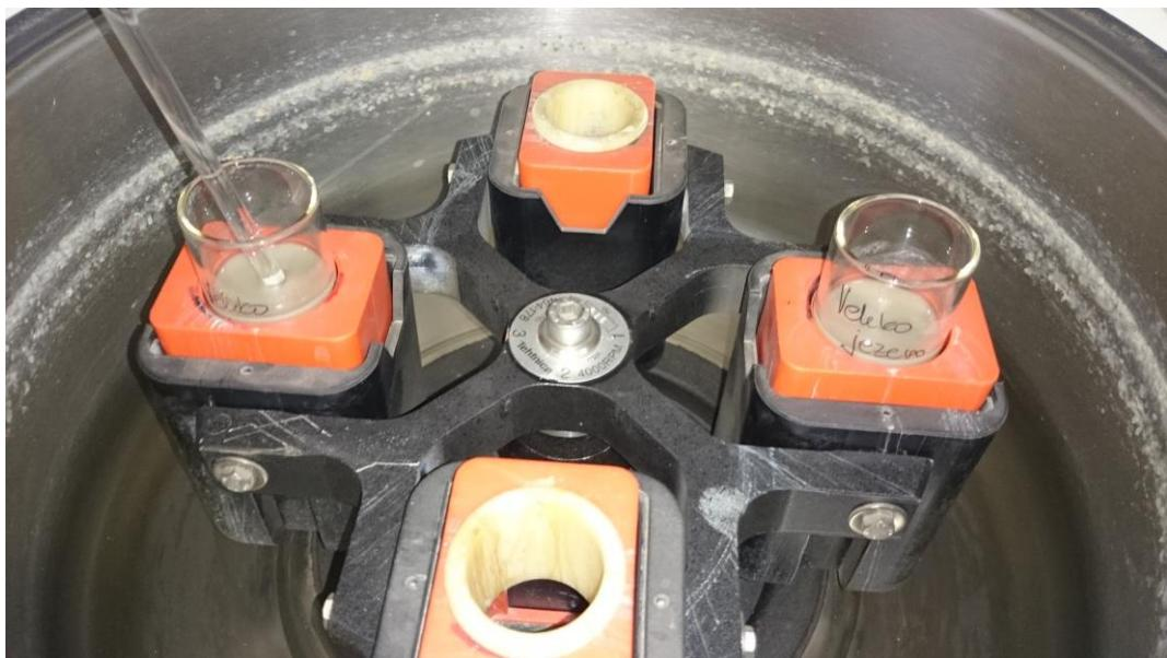
**Slika 12.** Uređaj za centrifugu (Tehnica/Centric 322A).
