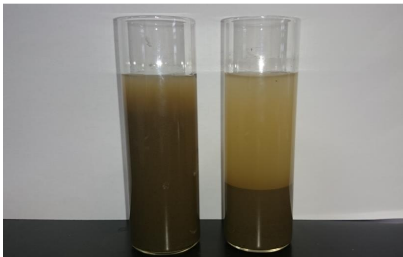
Slika 11. Prikaz sedimenta u kivetama prije centrifugiranja.
