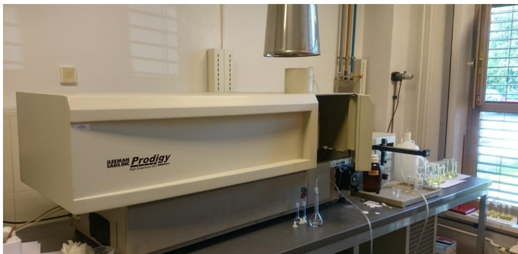
Slika 15. Uređaj za atomsku emisijsku spektroskopiju (ICP); Zavodu za analitičku kemiju, Kemijskog odsjeka PMF-a u Zagrebu.
