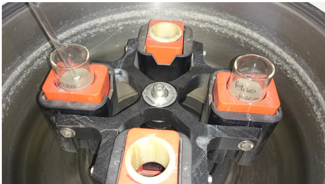
Slika 12. Uređaj za centrifugu (Tehtnica/Centric 322A).
