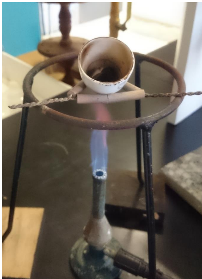
Slika 18. Prikaz spaljivanja filter papira na plameniku.
