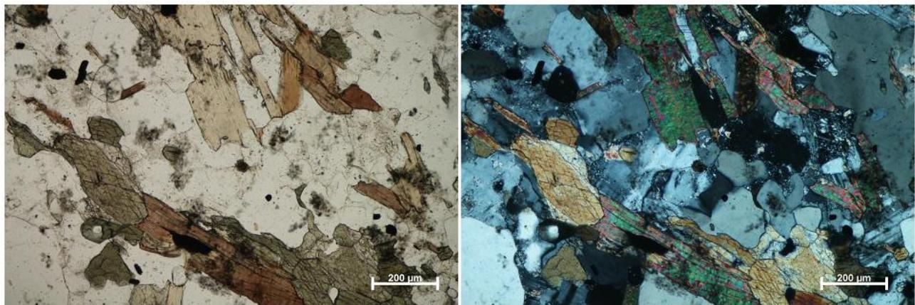
**Slika 29. Uzorak PUK6: Tanka lama građena od preferirano orijenitiranih biotita i horblende između kojih se nalaze zrna rekristaliziranog kvarca i plagioklasa. PPL, N- (lijevo), N+ (desno).**
