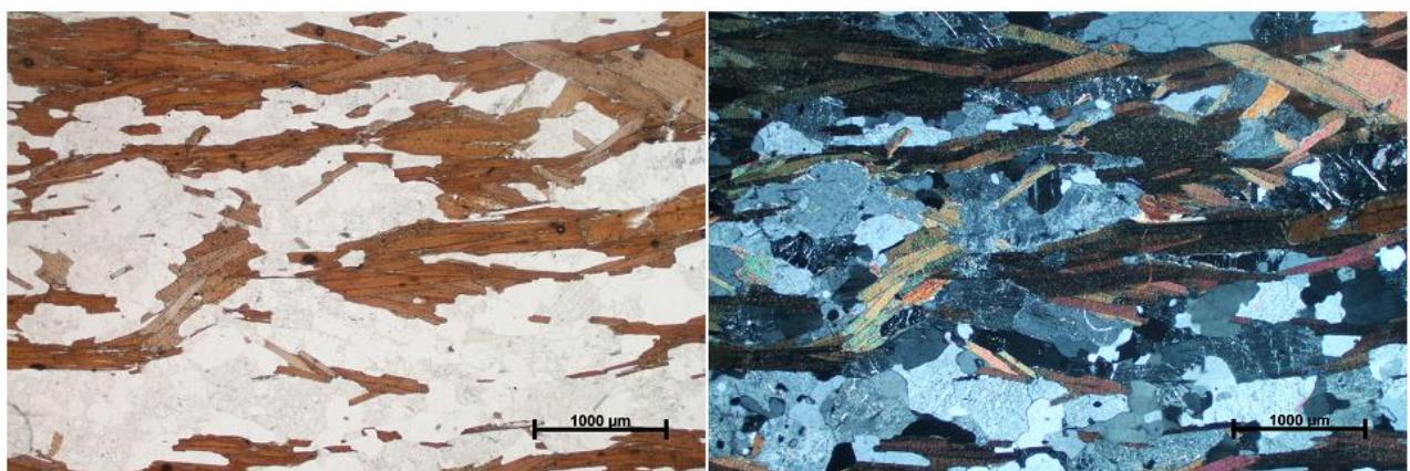
**Slika 22. Uzorak PUK5:** Između tankih biotitnih lama nalaze se leće ili proslojci kvarca i feldspata. Na slici se mogu uočiti brojna zrna cirkona s crnim metamiktnim ovojima uklopljena u biotitima. PPL, N- (lijevo), N+ (desno).
