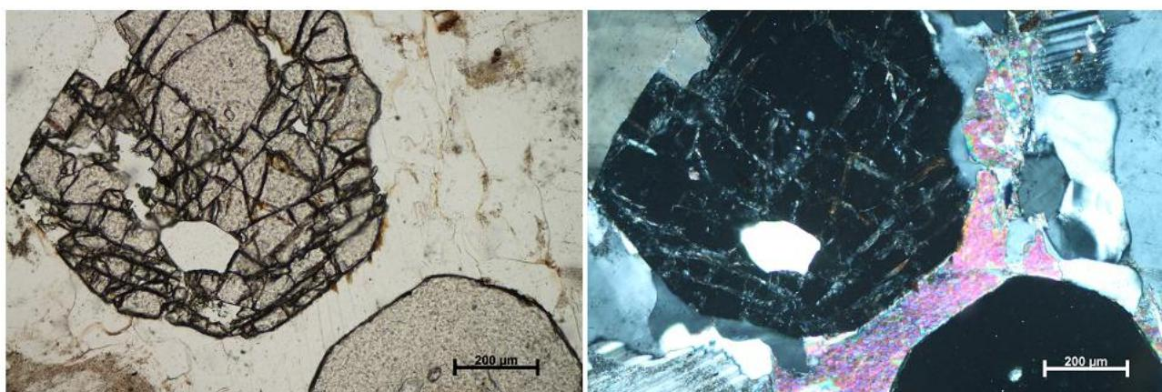
**Slika 21.** Porfiroblasti granata pri većem povećanju okruženi zrnima muskovita, kvarca i plagioklasa. U većem zrnu može se uočiti nepravilan uklopak kvarca. PPL, N- (lijevo), N+ (desno).
