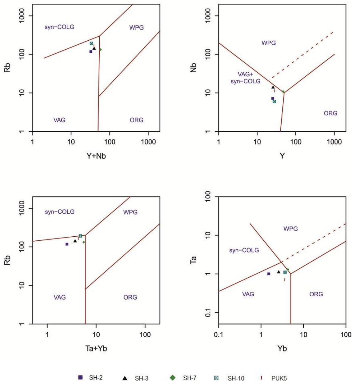
**Slika 37. Tektonska diskriminacija za granite prema PEARCE et al. (1984).** Kratice na dijagramima: VAG – graniti vulkanskih lukova (Volcanic Arcs Granites); syn-COLG – sinkolizijski graniti (Syncollision Granites); WPG – graniti unutar ploča (Within Plates Granites); ORG- graniti srednjooceanskog grebena (Ocean Ridge Granites).
