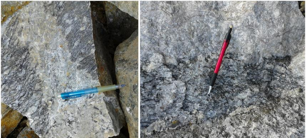
Slika 5. Fotografije stijena u kamenolomu. Na slici lijevo prikazana su dva različita tipa ortognajseva koje presijeca granitna žila. Na slici desno prikazan je kontakt između granita i migmatitnog gnajsa.
