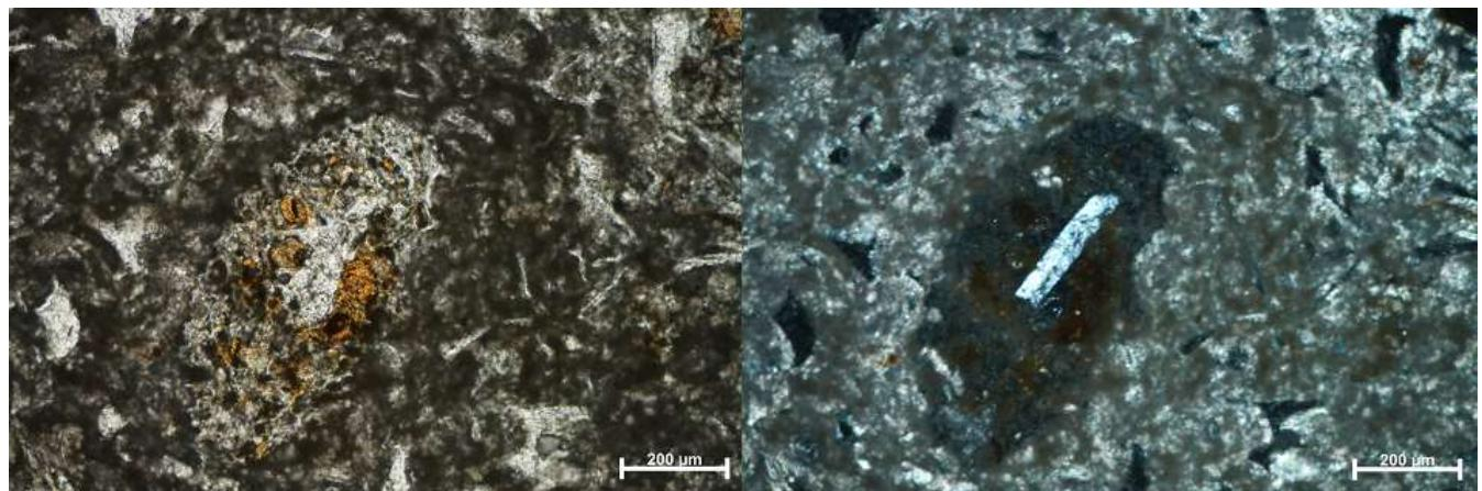
Slika 5.2.8. Mikrofotografija izbruska iz uzorka A.G.-7. Vidi se mineralno zrno plagioklaza unutar plovučca (Lijeva slika bez analizatora, desna slika s analizatorom)
