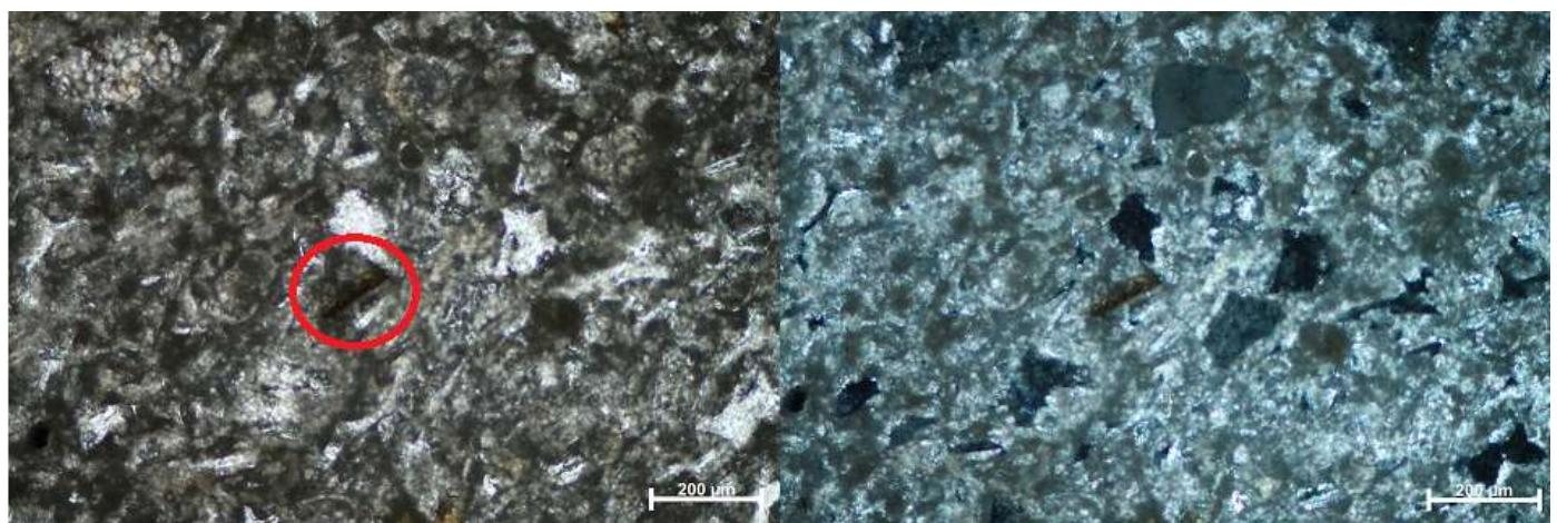
**Slika 5.2.6. Mikrofotografija izbruska iz uzorka A.G.-7. Vidi se mineralno zrno biotita štapićastog oblika (Ljeva slika bez analizatora (crveno zaokruženo mineralno zrno biotita), desna slika s analizatorom)**
