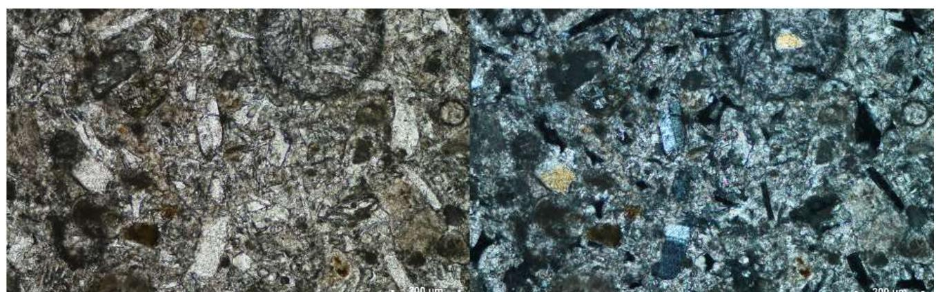
Slika 5.2.9. Mikrofotografija izbruska iz uzorka A.G.-7. Vide se mineralna zrna plagioklaza (Lijeva slika bez analizatora, desna slika s analizatorom)
