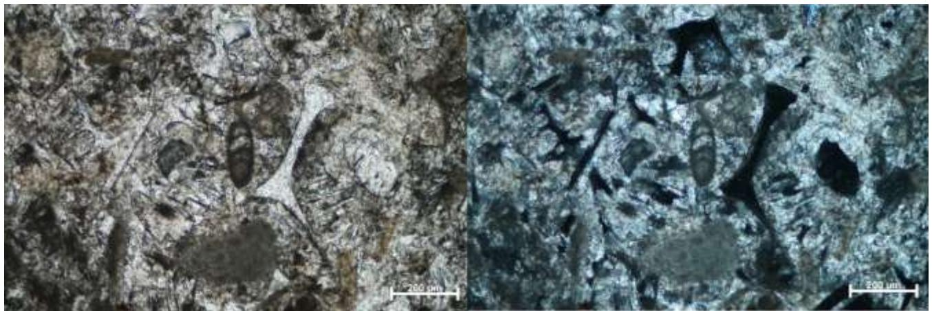
**Slika 5.2.11. Mikrofotografija izbruska iz uzorka A.G.-7. Vidi se fosilni sadržaj (Ljeva slika bez analizatora, desna slika s analizatorom)**
