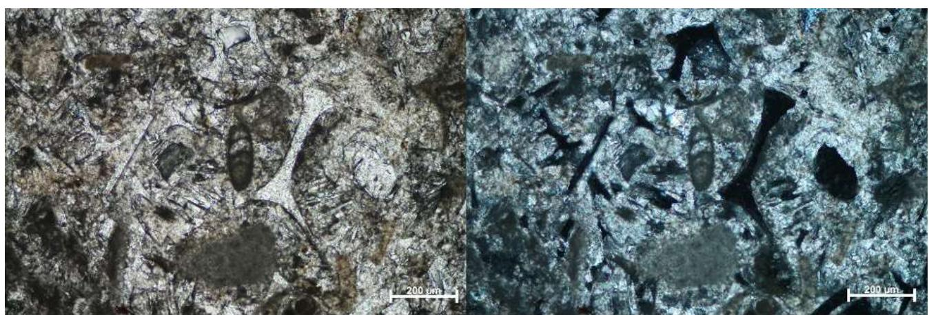
Slika 5.2.2. Mikrofotografija izbruska iz uzorka A.G.-7. Vide se štapićasti i češljasti oblici vulkanskog stakla (Lijeva slika bez analizatora, desna s analizatorom)
