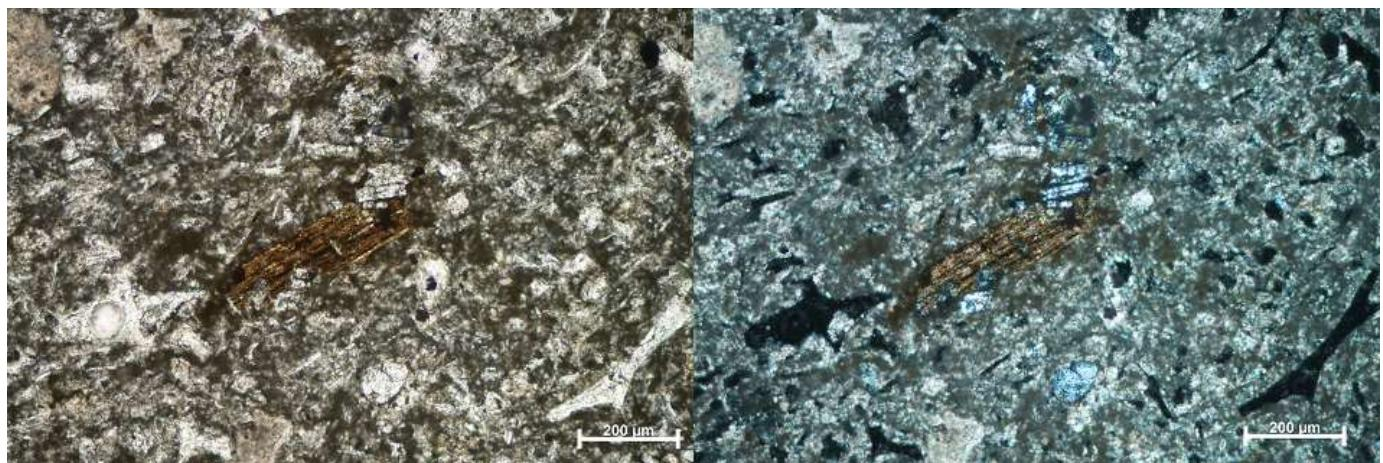
**Slika 5.2.5. Mikrofotografija izbruska iz uzorka A.G.-7. Vidi se mineralno zrno biotita veličine oko 0,200 mm
