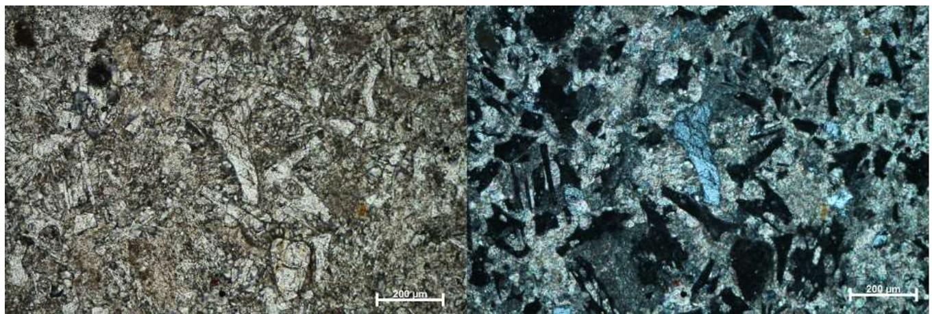
**Slika 5.2.10. Mikrofotografija izbruska iz uzorka A.G.-7. Vidi se mineralno zrno plagioklasa (Ljeva slika bez analizatora, desna s analizatorom)**
