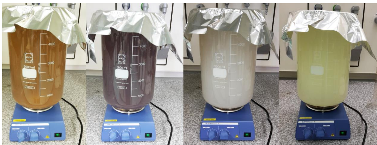
Slika 10. Promjena boje reakcijske smjese tijekom sinteze nanočestica cerijevog oksida.
