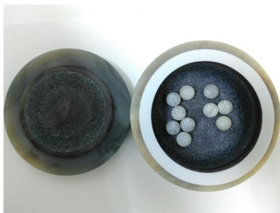
Slika 3.4. Ahatna posudica i kuglice za kuglični mlin Fritsch .
