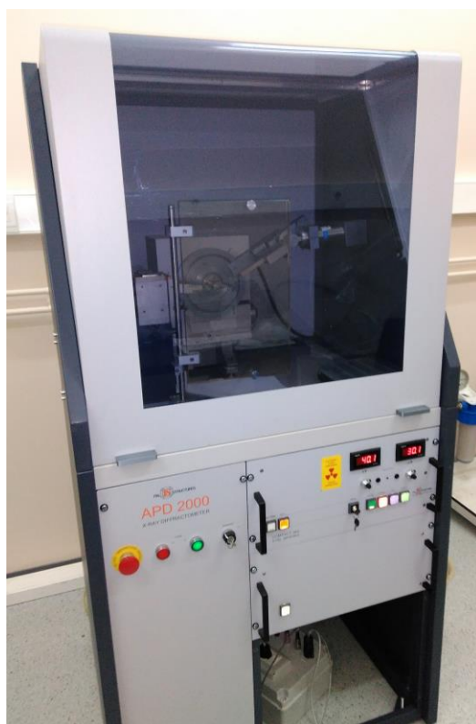
Slika 3.7. ItalStructures difraktometar APD 2000 za difrakciju na prahu.
