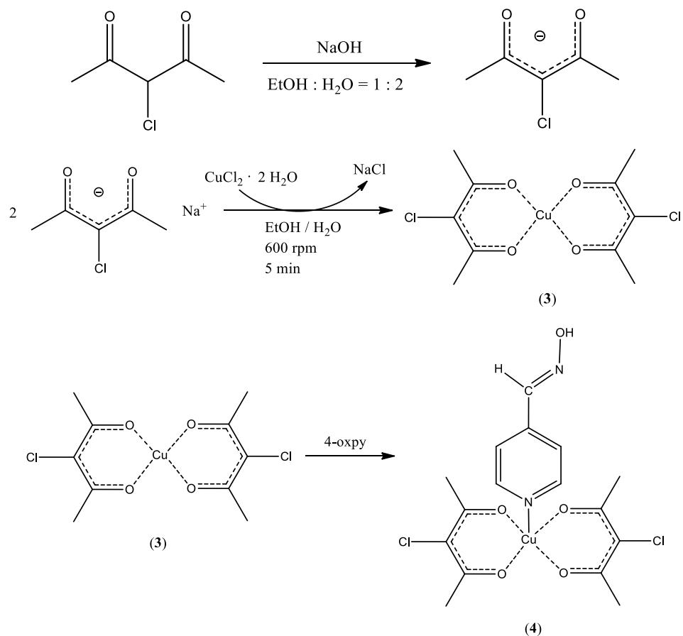
Slika 24. Shema sintetskih postupaka priprave spoja **4**
