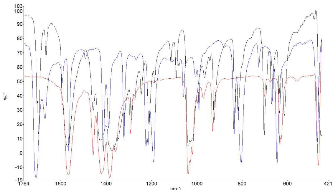
**Slika 25.** Usporedba otiska prsta ATR spektara spoja **4** dobivenog mehanokemijskom sintezom u tarioniku nakon sušenja u eksikatoru iznad natrijeva hidroksida (crno), spoja **1** (crveno) i piridin-4-karbaldehid a (crno)
