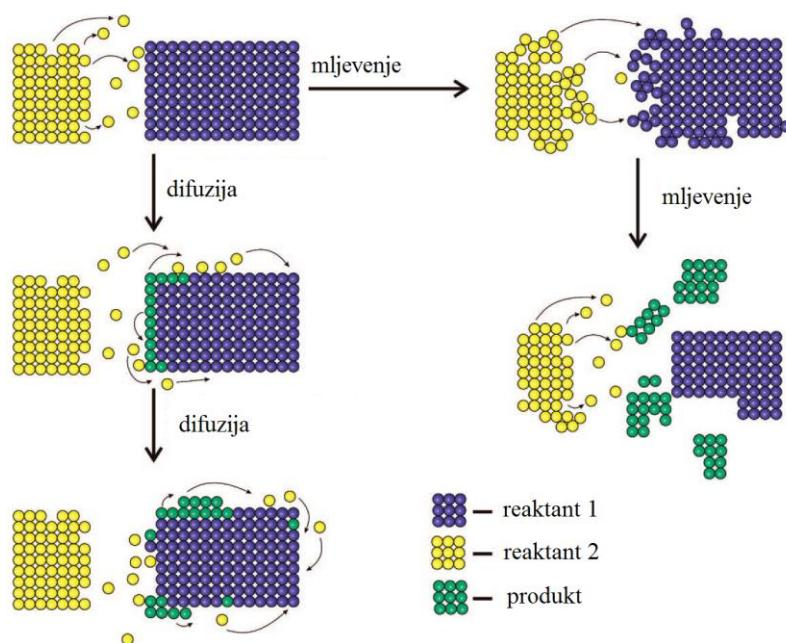
Slika 19. Shematski prikaz nastajanja produkta difuzijom i mljevenjem<sup>319</sup>
