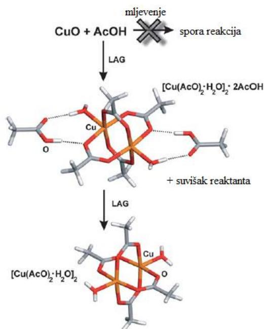
Slika 22. Shematski prikaz dobivanja bakrova(II) acetata mehanokemijskom sintezom<sup>372</sup>
