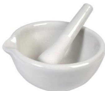
Slika 17. Tarionik i tučak za mehanokemijsku sintezu
