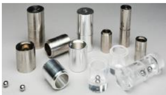
Slika 2.15. Posudice za mljevenje od čelika, aluminija i prozirnog PMMA (polimetilmetakrilata) u različitim veličinama (slika preuzeta iz izvora 37)
