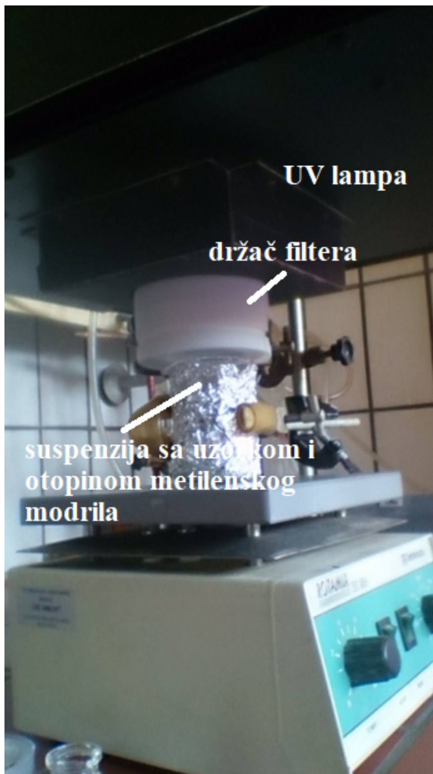
Slika 6. Prikaz postavljenog eksperimenta za određivanje fotokatalitičke aktivnosti
