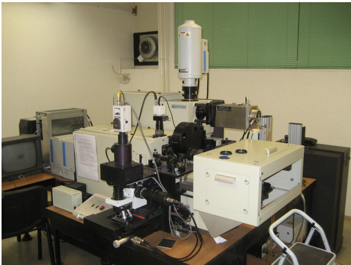
Slika 8. Horiba JobinYvon T64000 mikro Raman sustav 33
