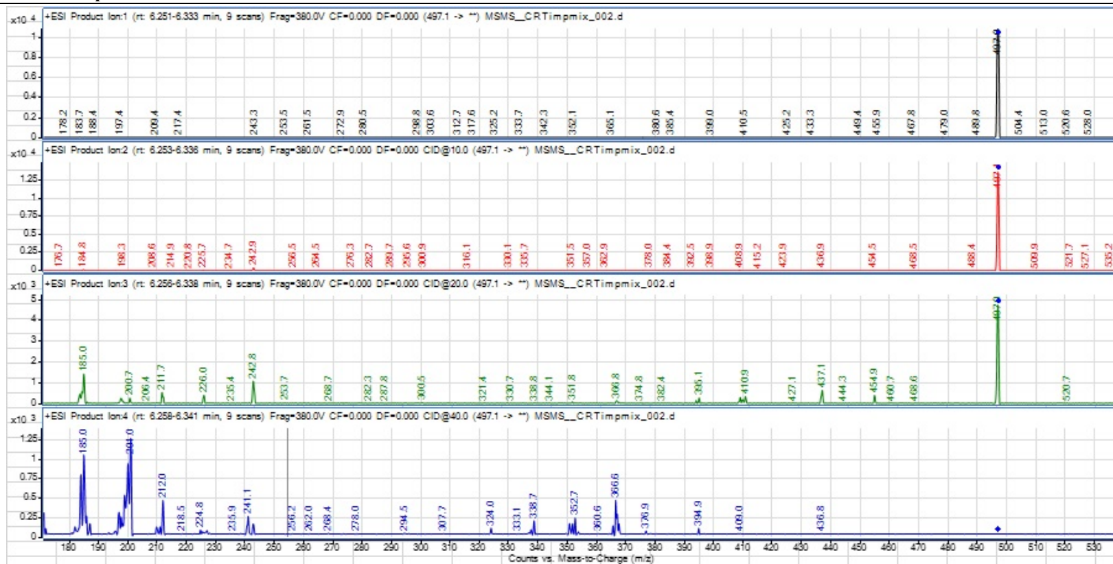
Slika 18. MS/MS spektar onečišćenja IMP27 pri svim kolizijskim energijama (0, 10, 20, 40 eV)
