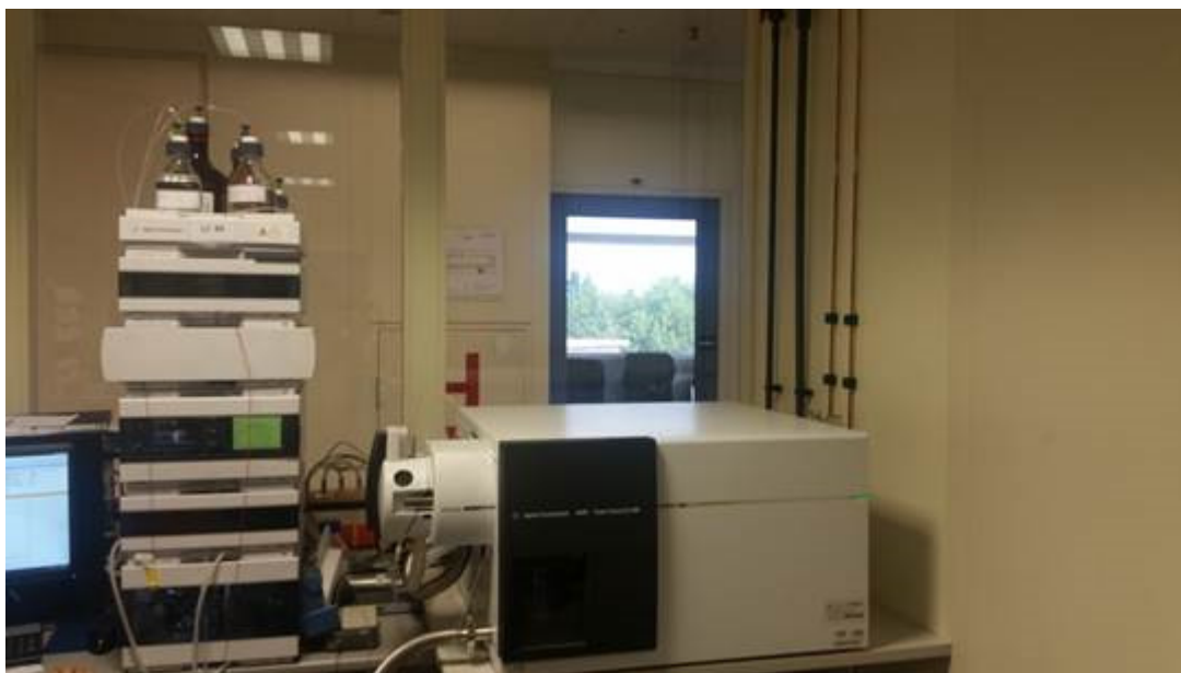
Slika 6. Tekućinski kromatograf ultravisoke djelotvornosti vezan sa spektrometrom masa s trostrukim kvadropolom, Agilent 6490
