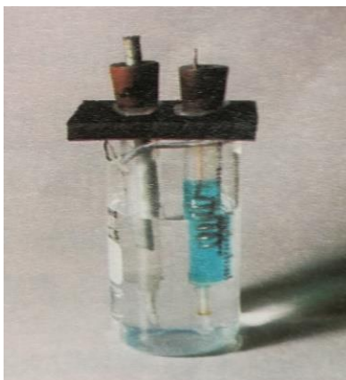
Slika 3. Polučlanci \text{Zn}^{2+}|\text{Zn} i \text{Cu}^{2+}|\text{Cu} u injekcijskim štrcaljkama uronjeni u otopinu elektrolita (vodena otopina natrijevog klorida). 11
