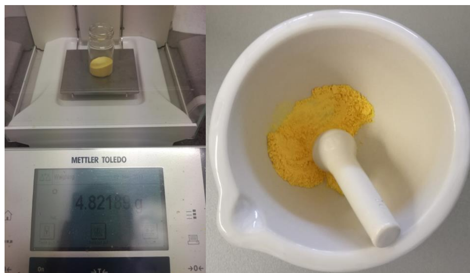
Slika 6. Sintetizirane čestice cerijeva oksida.
