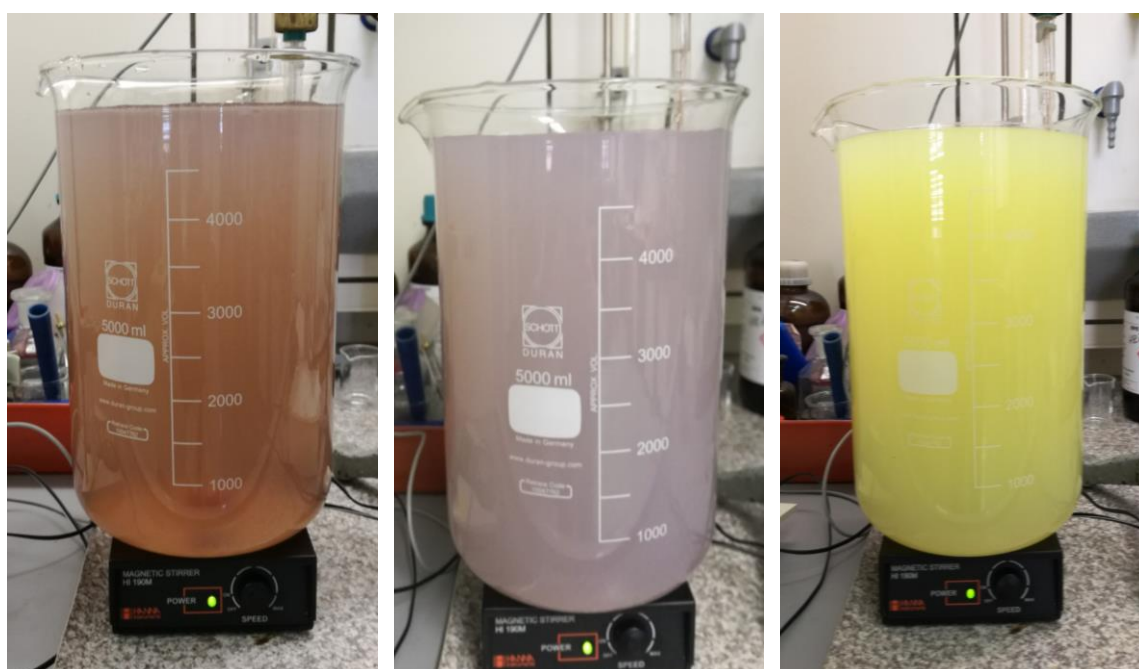
Slika 5. Suspenzija čestica cerijeva oksida tijekom sinteze.
