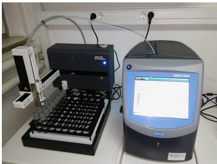
Slika 8. Autosampler a) injektiranje H_3PO_4 u uzorke; b) ekran s prikazom detekcije CO_2 signala; d) cijeli prikaz analizatora za određivanje ugljika u tekućim uzorcima.
