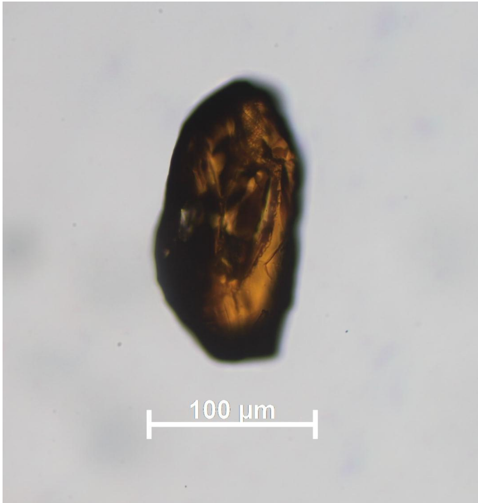
Slika 18. Uzorak MR-6, rutil bez uključenog analizatora
