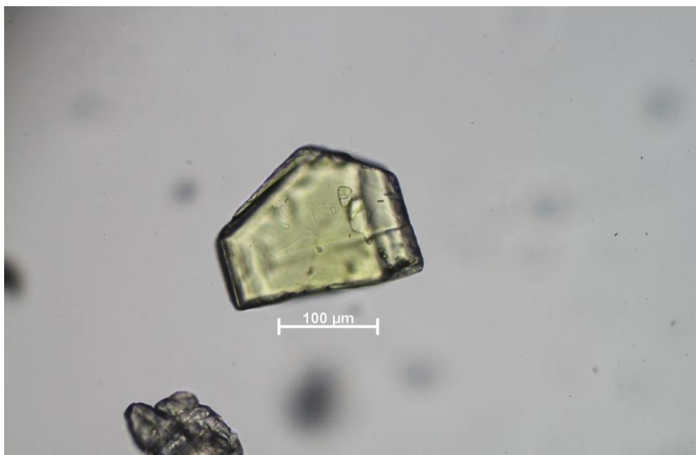
Slika 15. Uzorak MR-6, epidot bez uključenog analizatora
