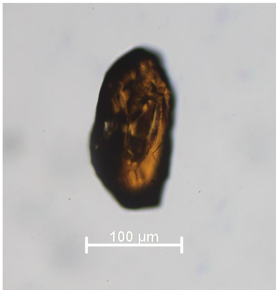
Slika 18. Uzorak MR-6, rutil bez uključenog analizatora
