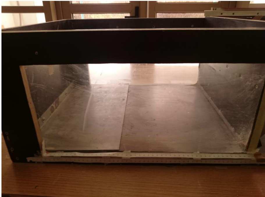
Slika 17: Set limova postavljen u aparaturu kako bi se dobio efekt maksimalne kompresije u centru postavljenog materijala, a ne samo ispred pomičnog zida.
