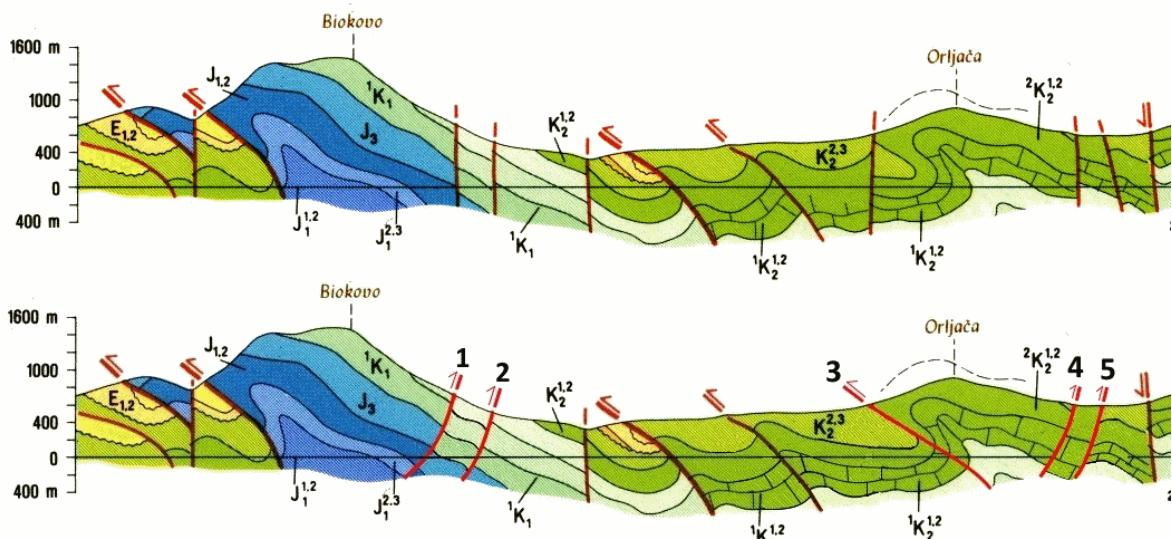
**Slika 38:** Usporedba originalnog dijela geološkog profila A-B sa Lista Imotski Osnovne geološke SFRJ (Raić et al., 1977) s geološkim profilom modificiranim uz pomoć pokusa P3. Gore: dio profila A-B sa Lista Imotski Osnovne geološke karte SFRJ (Raić et al., 1976). Dolje: Modificirani geološki profil A-B OGK lista Imotski, kada bi u interpretaciji bile primijenjene spoznaje iz P3. Izmijenjeni su karakteri rasjeda označenih sa 1, 2, 3, 4 i 5.
