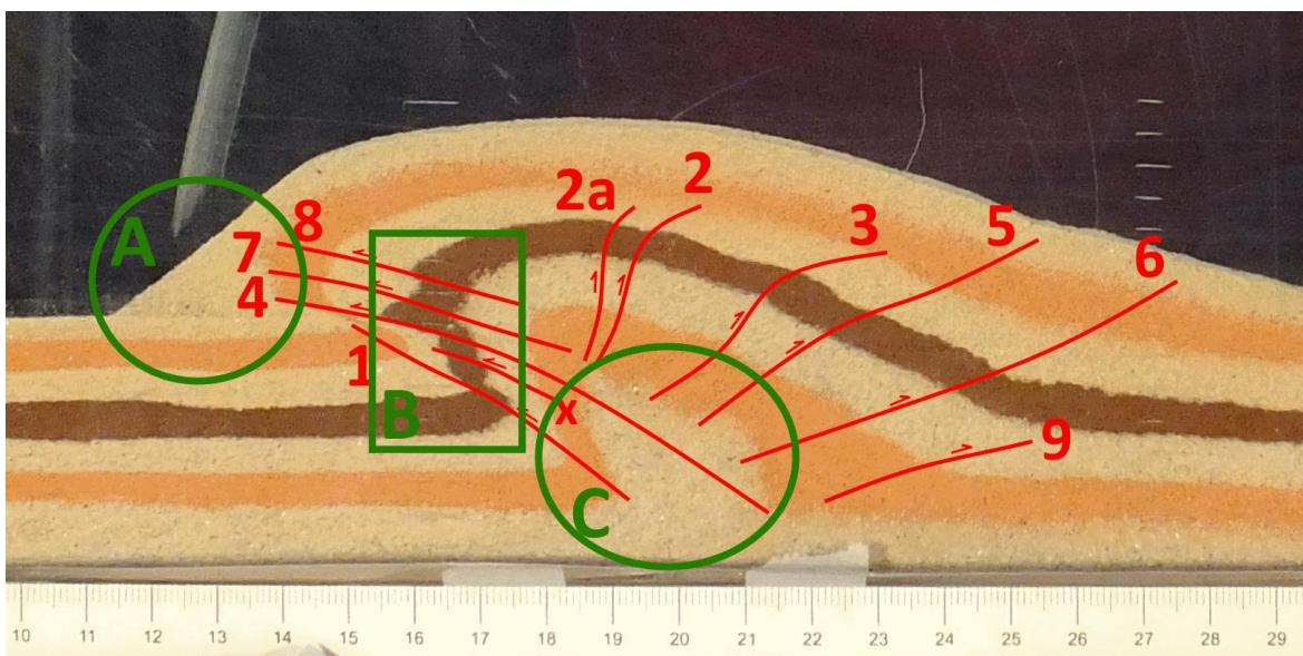
**Slika 36:** Pokus P3 pri fazi kompresije 30%. A: Vidljivo je gravitacijsko zadebljanje najmladeg sloja u čelu navlake (antiklinale); B: Sloj kave zbog geneze strukture dolazi u subvertikalni položaj; C: Zadebljanje najstarijeg sloja pri dnu seta navlačnih rasjeda.
