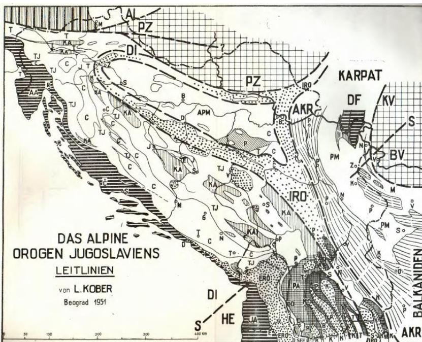
**Slika 1:** Koberova (1952) tektonska podjela Dinarida. DI: Dinaridi; HE: Helenidi; IRO: unutarnja radiolaritska zona; AKR: “stari kristalin“; PZ: Vanjska Panonska masa; APM: Unutarnja Panonska masa; EPM: vanjska zona; C: navlaka Visokog krša; KA: škriljavovo-rožnjačka navlaka; AL: Alpe
