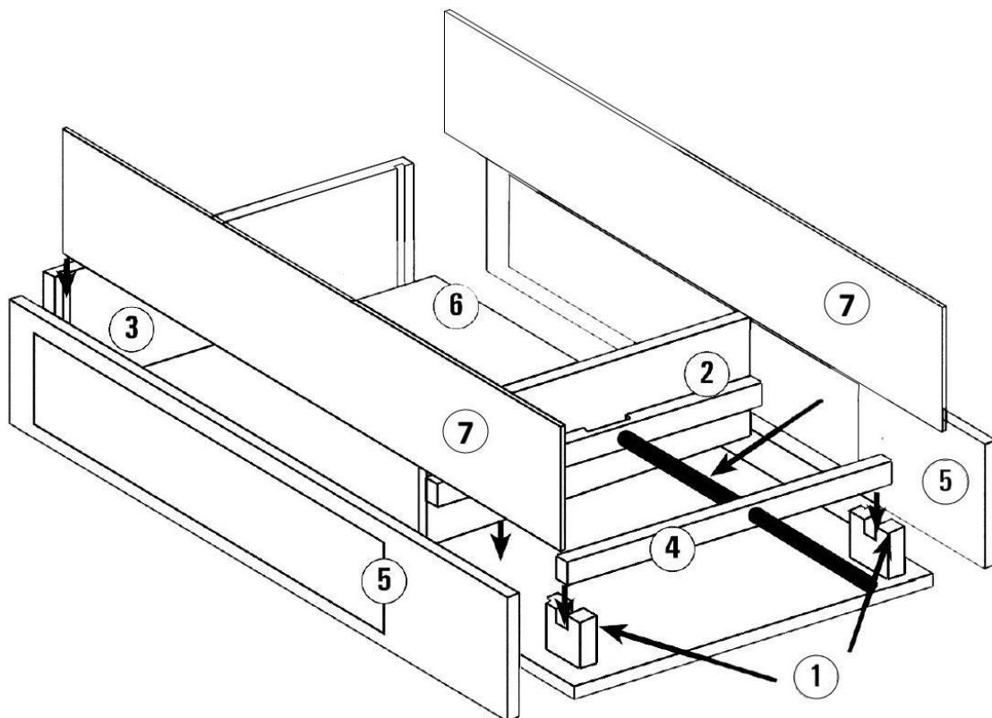
**Slika 13:** Konstrukcijski nacrt aparature. Dijelovi: (1) nosači potporne grede navoja, (2) pomični zid, (3) fiksni zid, (4) potporna greda navoja, (5) bočne stranice aparature s prozorom, (6) bazna ploča, (7) bočne stranice od pleksiglasa [1].
