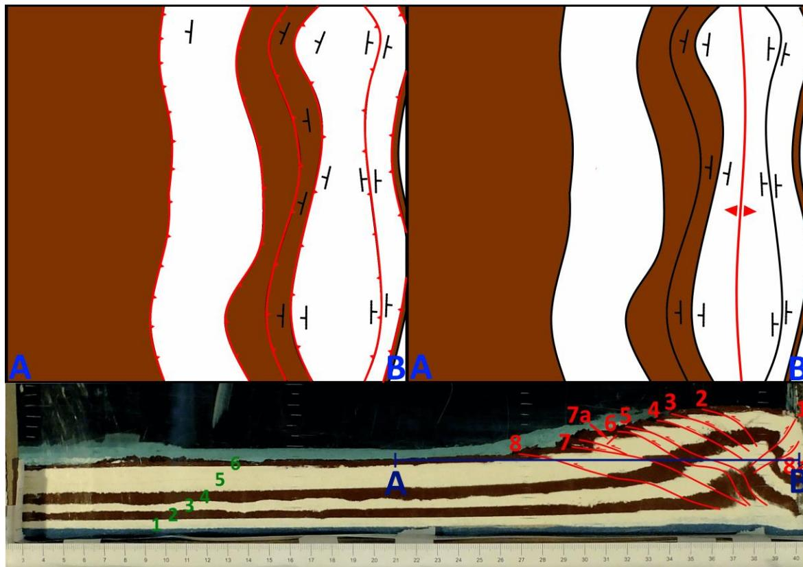
**Slika 32:** Pojednostavljena geološka karta po horizontu označenom na profilu (AB). Na gore lijevoj slici je vidljiva ispravno interpretirana karta s ucrtanim rasjedima. Na gore desnoj slici je vidljiva moguća kriva interpretacija na temelju položaja slojeva i rasporeda stratigrafskih jedinica (u tjemenu pseudoantiklinale je najstariji, a u krilima mlađi slojevi) na kojoj su rasjedi ucrtani kao geološke granice, a struktura označena kao antiklinala.
