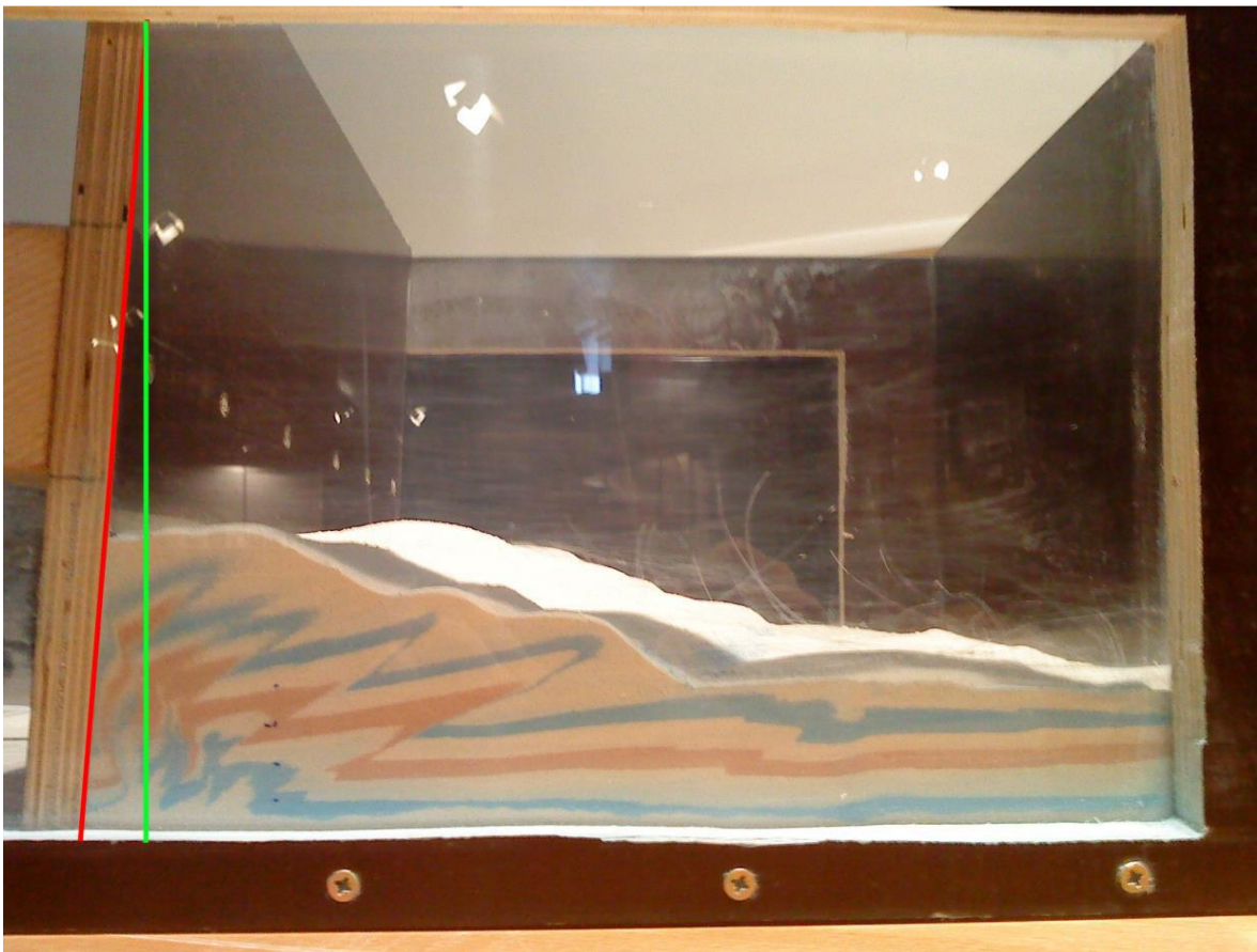
Slika 15: Jedan od pokusa iz 2015. Uočljivo je naginjanje pomičnog zida kao nedostatak izvornog dizajna aparature.
