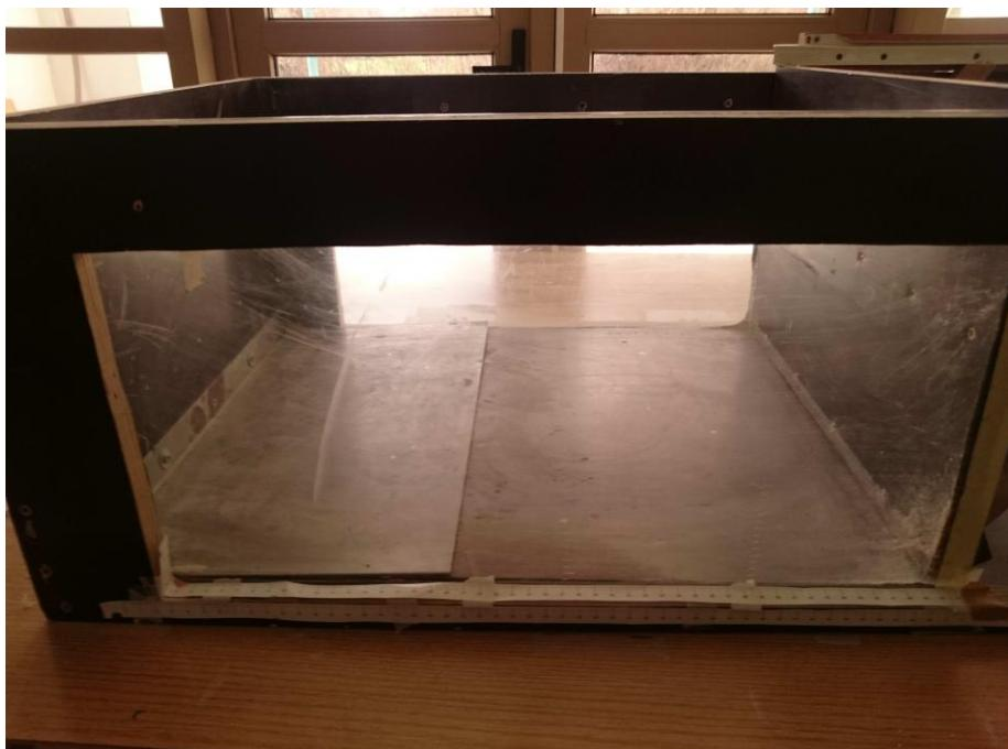
**Slika 17:** Set limova postavljen u aparatu kako bi se dobio efekt maksimalne kompresije u centru postavljenog materijala, a ne samo ispred pomičnog zida.
