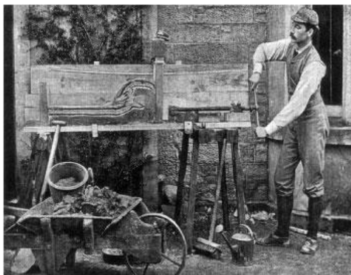
Slika 12: Cadell (1888) demonstrira svoju aparaturu za čisto smicanje, u kojoj je deformirao slojeve gline kako bi proučavao kompresijske strukture (Koyi, 1997).
