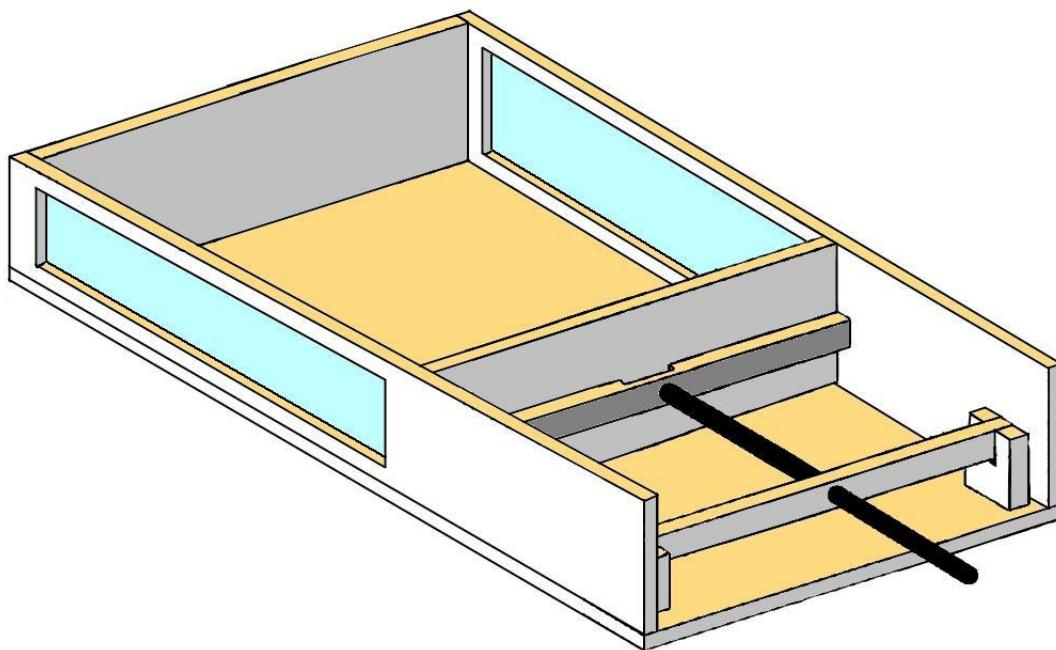
**Slika 14:** Shematski prikaz sastavljene aparature u nemodificiranoj verziji.
