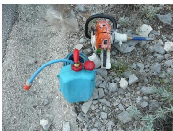
Slika 10: Bušeca aparatura koja se koristi za paleomagnetsko uzorkovanje.
