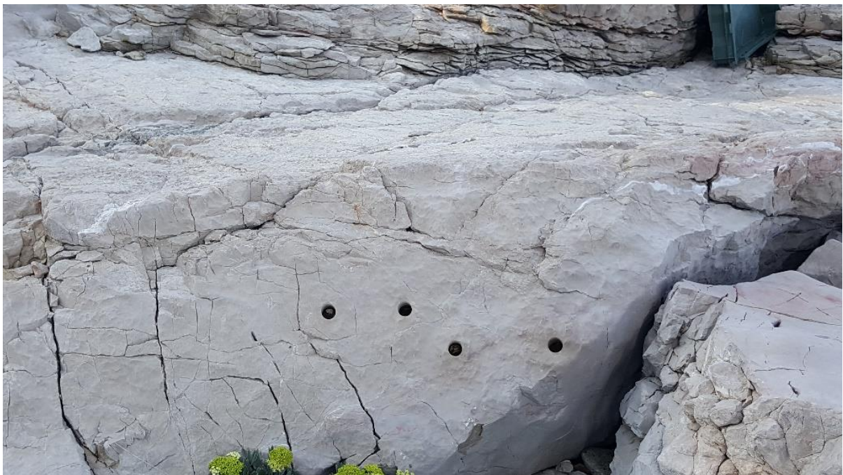
Slika 11: Debelo uslojeni vapnenci iz uvale Likva (distribucija paleomagnetskih jezgara 1270-1273 po slojnoj plohi)
