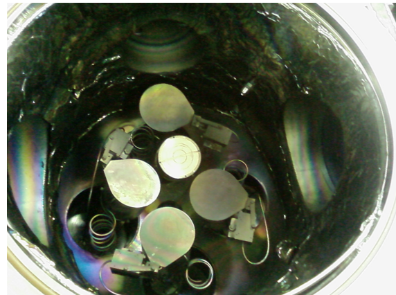
(b) Slika komore u kojoj se događa rasprašenje. U sredini se vide 4 kućišta za mete; 3 pokrivena, a 1 otkriveno. Za vrijeme depozicije prikazani se poklopci mogu otvarati i zatvarati po potrebi. Kroz jedan od otvora sa strane unosi se podloga na koju se deponira.
