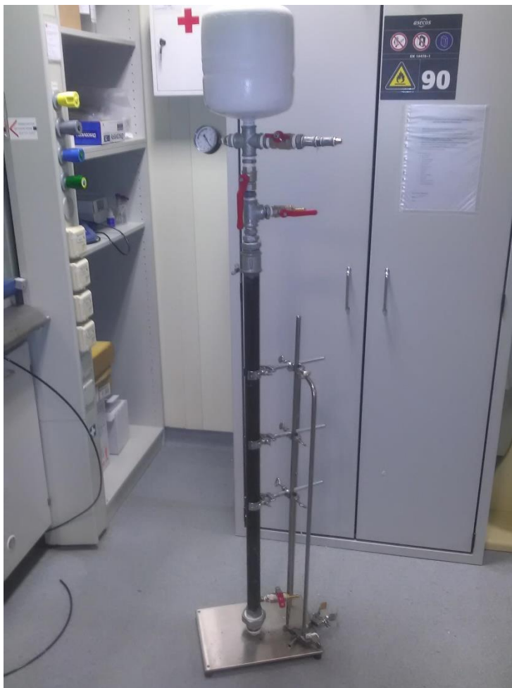
Slika 22 – Pneumatski top korišten za udarnu kompresiju
