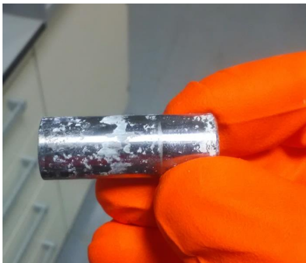
Slika 33 – Protisnuta krutina u pokusima spore udarne kompresije.
