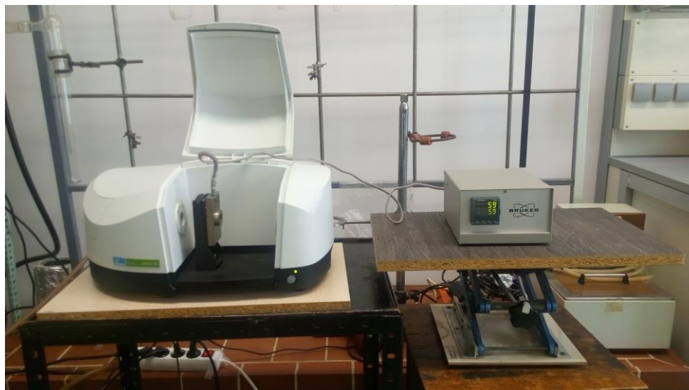
Slika 18. Nosač termobloka s KBr pastilom uzorka dimera spoja 1 u FT-IR spektrometru.
