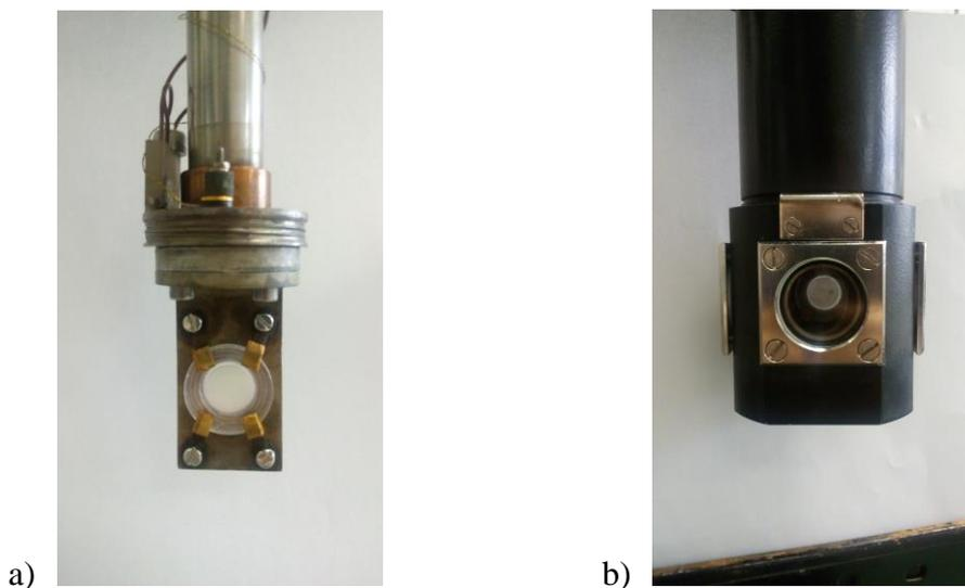
**Slika 16.** a) Nosач kriostata s KBr pastilom dimera spoja **1** pričvršćenog između dvije pločice cezijeva jodida; b) glava kriostata u kojoj je smješten nosač s uzorkom dimera.
