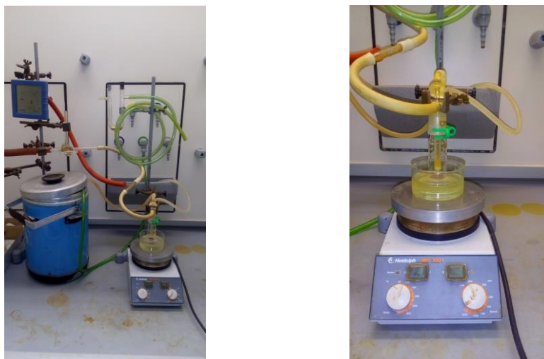
Slika 14. Aparatura za sublimaciju pri sniženom tlaku.
