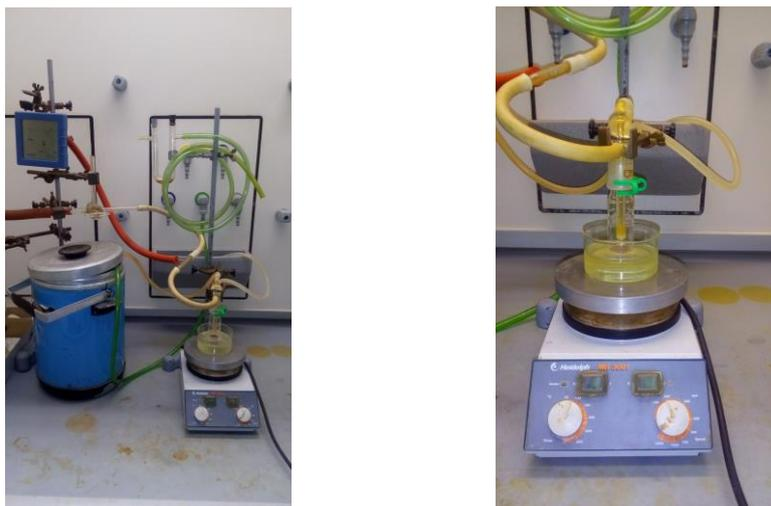
Slika 14. Aparatura za sublimaciju pri sniženom tlaku.
