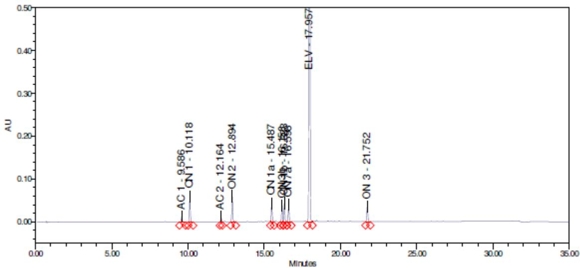
Slika 5. Kromatogram ELV i onečišćenja pri uvjetima  $t = 30$  min,  $T = 30$  °C i pH = 2,1
