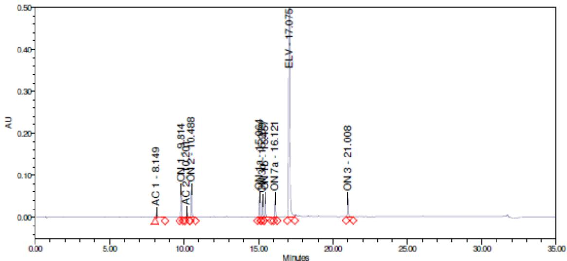
Slika 9. Kromatogram ELV i onečišćenja pri uvjetima  $t = 30$  min,  $T = 30$  °C i  $\text{pH} = 6,8$
