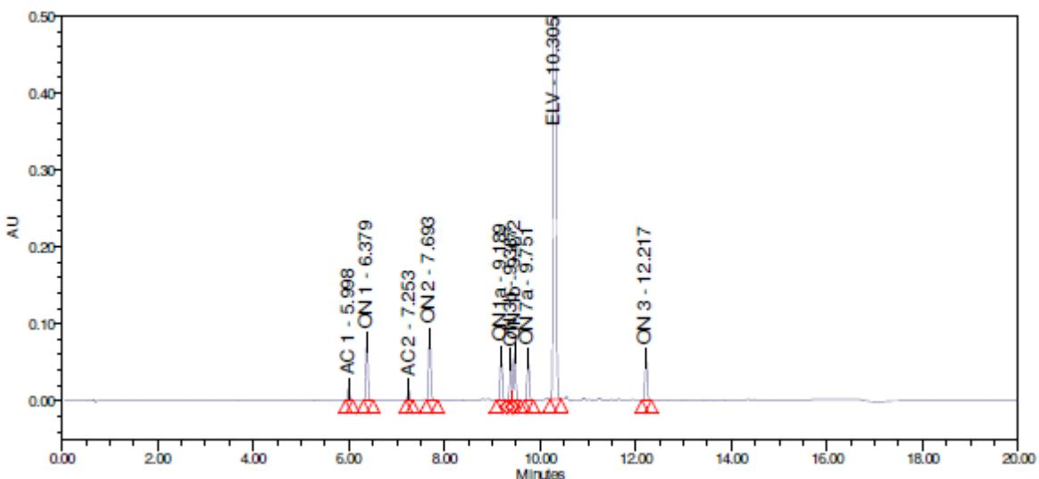
Slika 6. Kromatogram ELV i onečišćenja pri uvjetima  $t = 15$  min,  $T = 60$  °C i pH = 2,1
