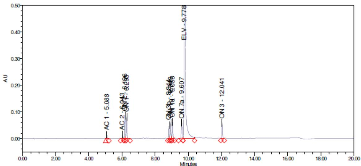
Slika 10. Kromatogram ELV i onečišćenja pri uvjetima  $t = 15$  min,  $T = 60$  °C i  $\text{pH} = 6,8$
