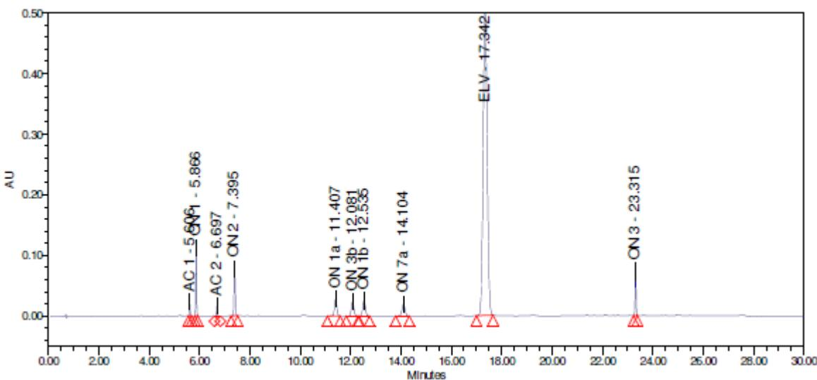
**Slika 20.** Kromatogram ELV i onečišćenja pri optimalnim uvjetima dobivenih pomoću DryLab,  $t = 30 \text{ min}$ ,  $T = 60^\circ\text{C}$ ,  $\text{pH} = 2,1$  i protok  $0,4 \text{ mL min}^{-1}$
