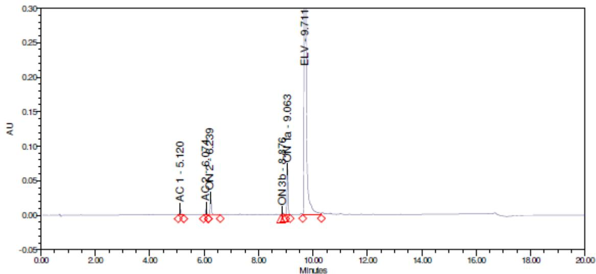
Slika D25. Kromatogram otopine IMP 1.1 pri uvjetima  $t = 15 \text{ min}$ ,  $T = 60^\circ\text{C}$  i  $\text{pH} = 6,8$
