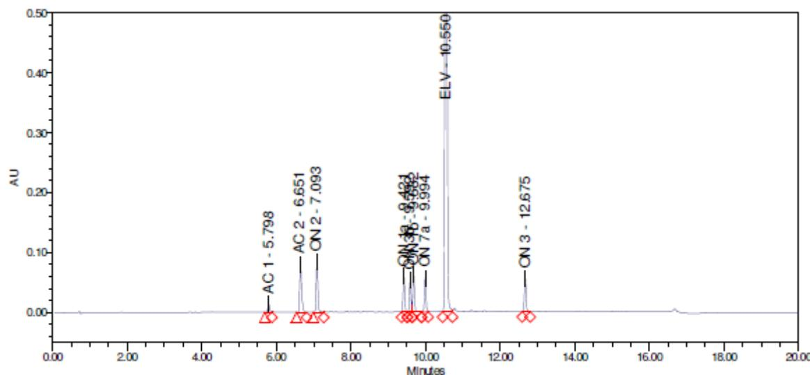
Slika 8. Kromatogram ELV i onečišćenja pri uvjetima  $t = 15$  min,  $T = 30$  °C i pH = 6,8
