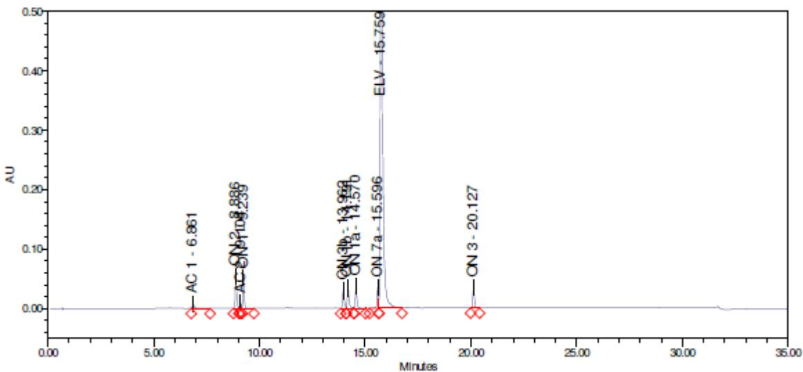
Slika 11. Kromatogram ELV i onečišćenja pri uvjetima  $t = 30$  min,  $T = 60$  °C i pH = 6,8
