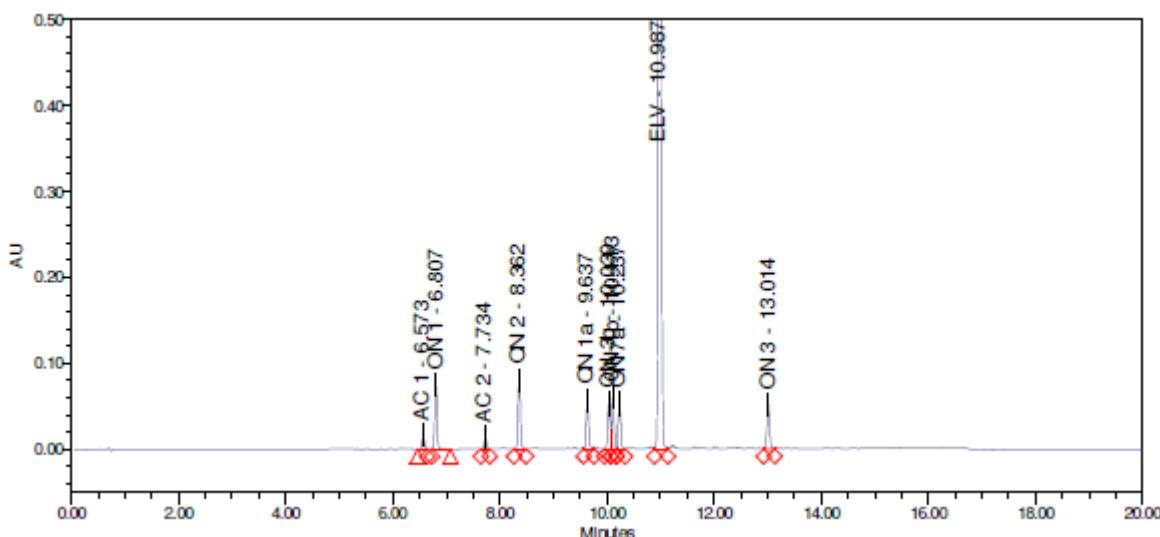
Slika 4. Kromatogram ELV i onečišćenja na koloni *Waters Aquity UPLC BEH C18*  $1,7\mu\text{m}$ ;
