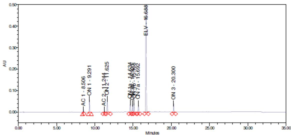
Slika 7. Kromatogram ELV i onečišćenja pri uvjetima  $t = 30$  min,  $T = 60$  °C i pH = 2,1
