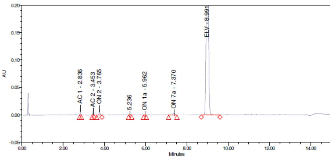
**Slika 26.** Kromatogram otopine ELV podvrgnute forsiranoj razgradnji u 30%  $\text{H}_2\text{O}_2$
