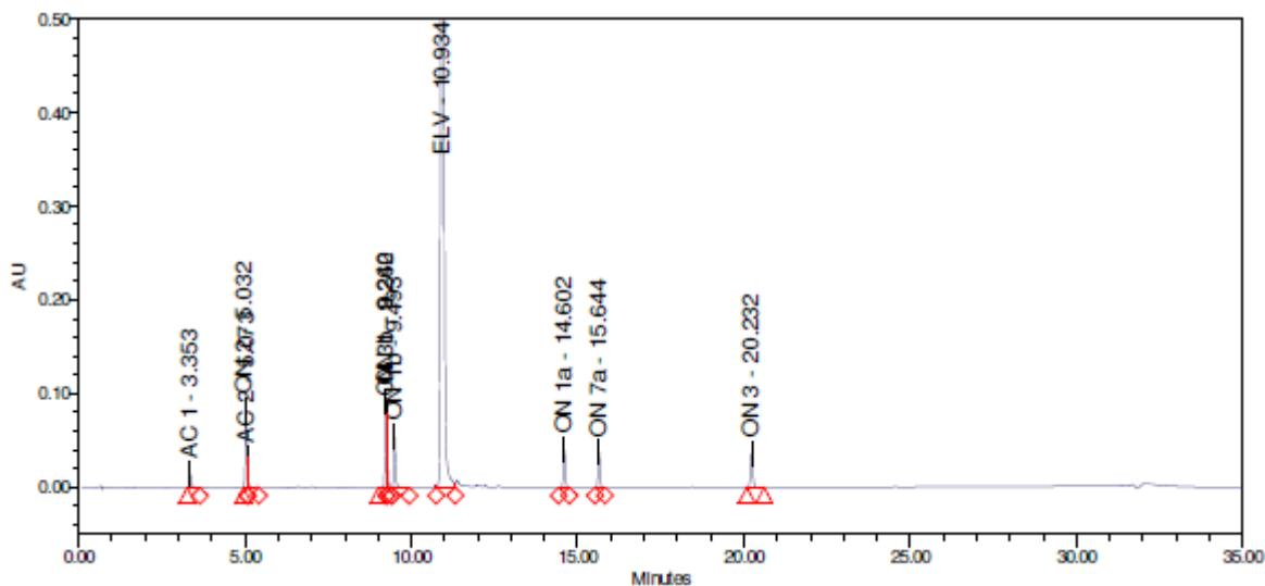
Slika 15. Kromatogram ELV i onečišćenja pri uvjetima  $t = 30$  min,  $T = 60$  °C i pH = 8,9
