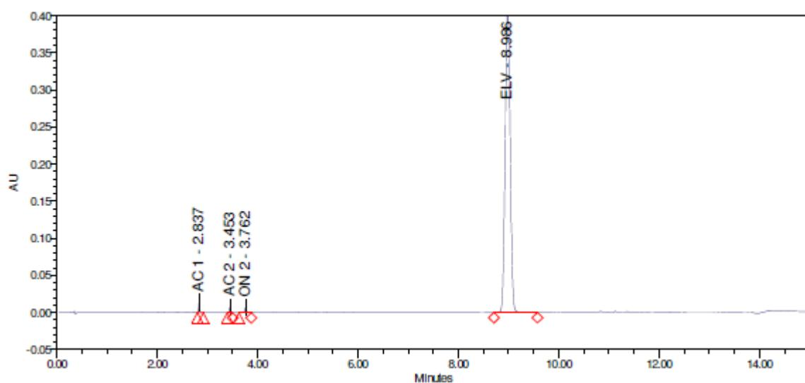
Slika 22. Kromatogram otopine ELV koncentracije  $1 \text{ mg mL}^{-1}$
