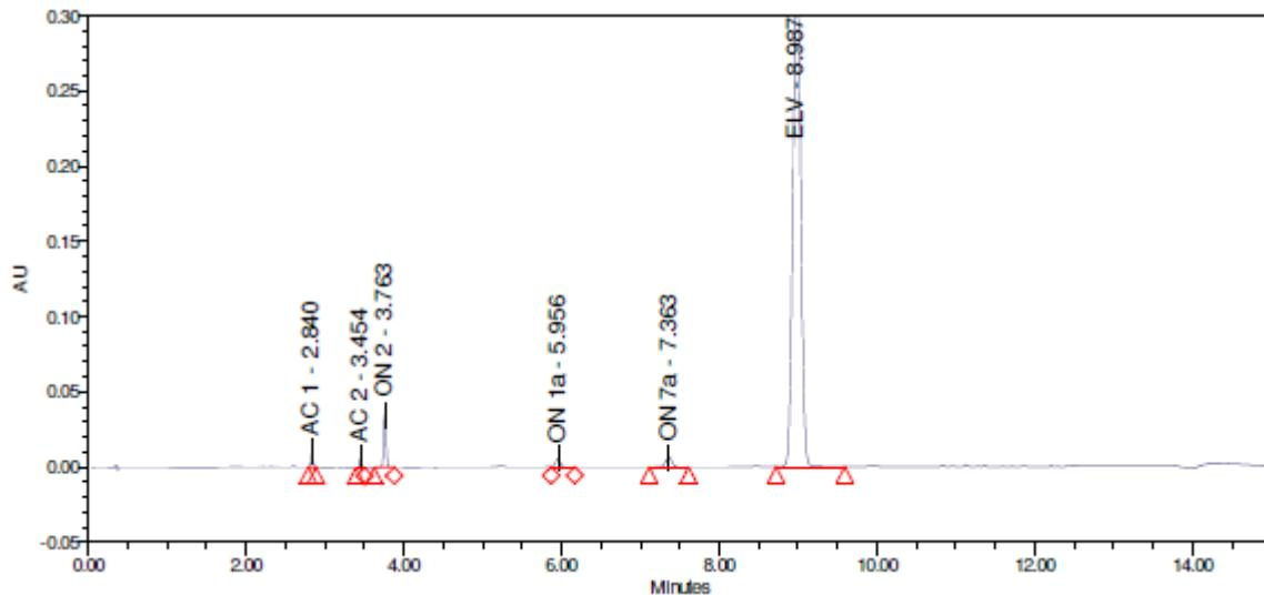
**Slika 25.** Kromatogram otopine ELV podvrgnute forsiranoj razgradnji u  $5 \text{ mol L}^{-1}$  NaOH
