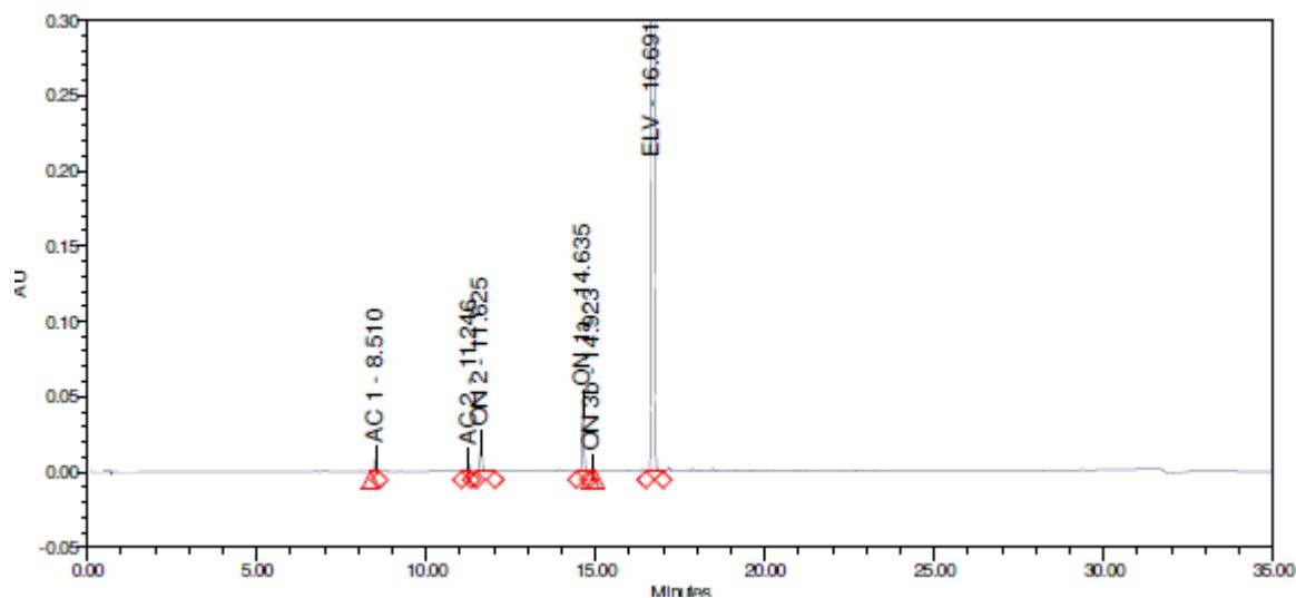
Slika D13. Kromatogram otopine IMP 1.1 pri uvjetima  $t = 30 \text{ min}$ ,  $T = 60^\circ\text{C}$  i  $\text{pH} = 2,1$
