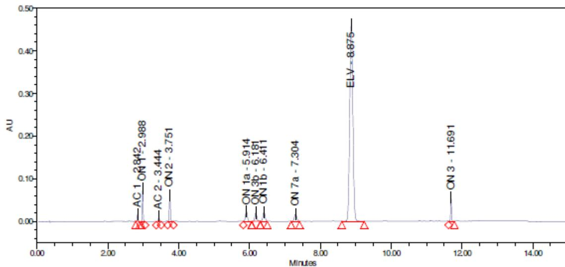
**Slika 22.** Kromatogram ELV i onečišćenja pri optimalnim uvjetima dobivenih pomoću DryLab,  $t = 15$  min,  $T = 60$  °C, pH = 2,1 i protok  $0,8 \text{ mL min}^{-1}$
