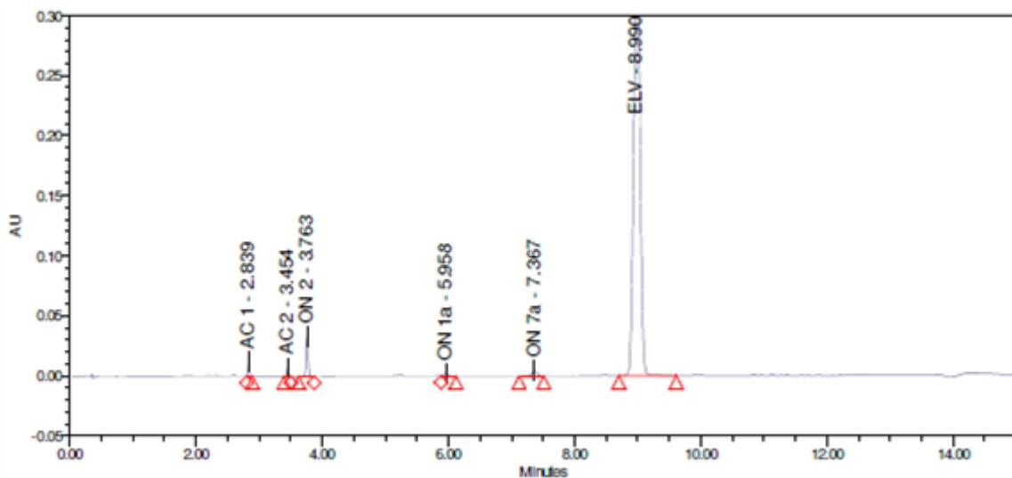
Slika 24. Kromatogram otopine ELV podvrgnute forsiranoj razgradnji u 5 mol L<sup>-1</sup> HCl
