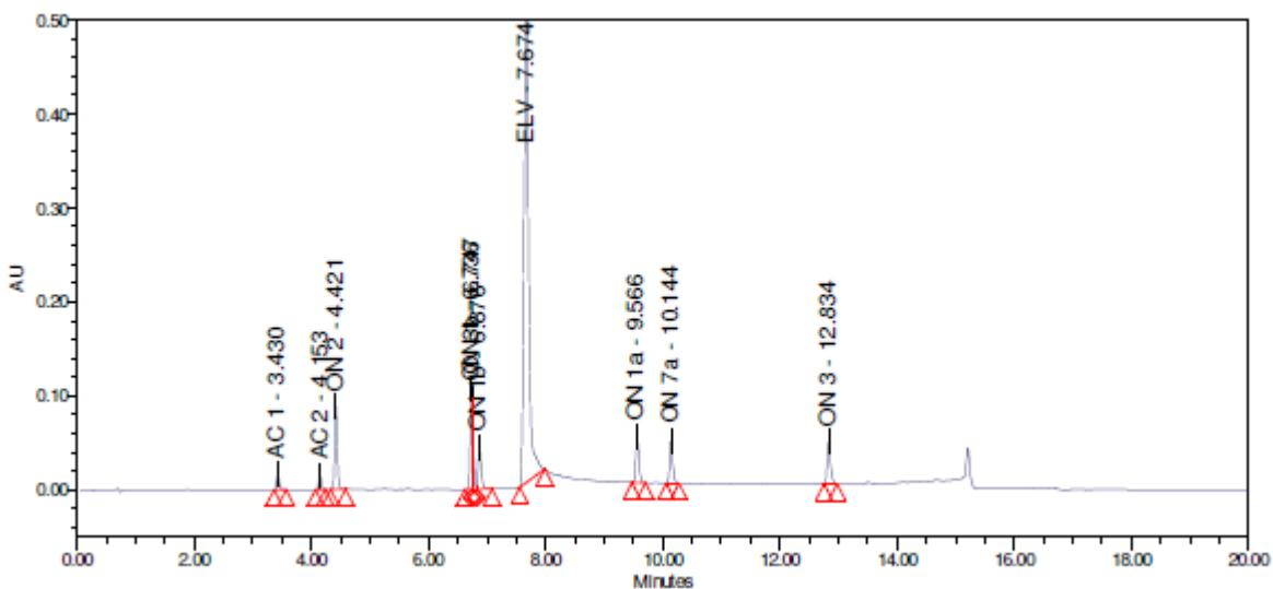
Slika 12. Kromatogram ELV i onečišćenja pri uvjetima  $t = 15$  min,  $T = 30$  °C i pH = 8,9
