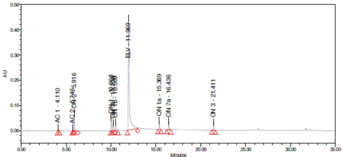
Slika 13. Kromatogram ELV i onečišćenja pri uvjetima  $t = 30$  min,  $T = 30$  °C i  $\text{pH} = 8,9$
