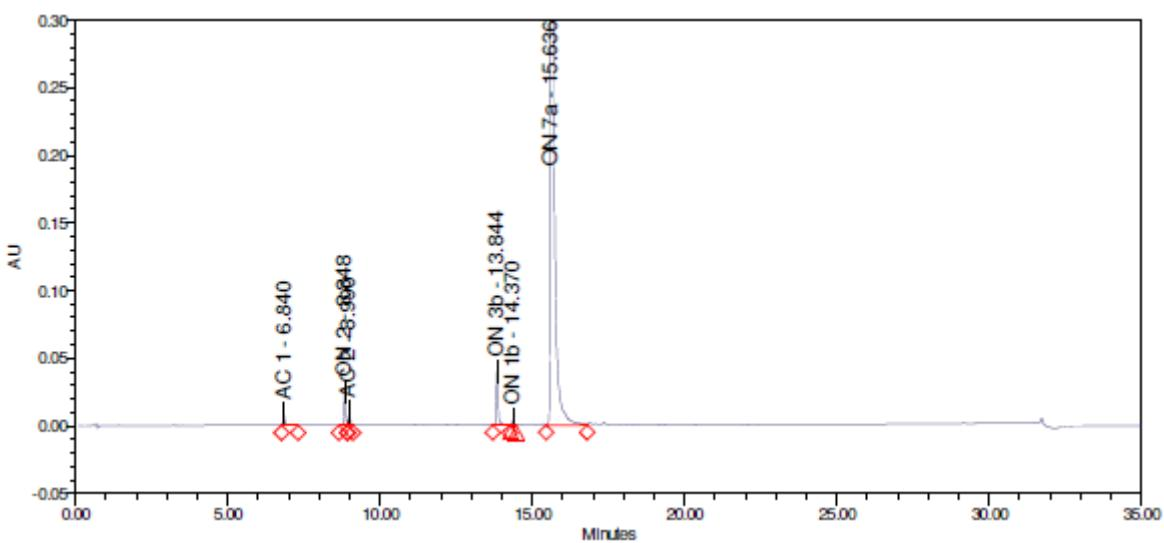
Slika D30. Kromatogram otopine IMP 1.2 pri uvjetima  $t = 30 \text{ min}$ ,  $T = 60^\circ\text{C}$  i  $\text{pH} = 6,8$
