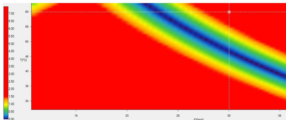
**Slika 17.** Grafički prikaz 2D računalnog modela dobivenog računalnim programom DryLab
