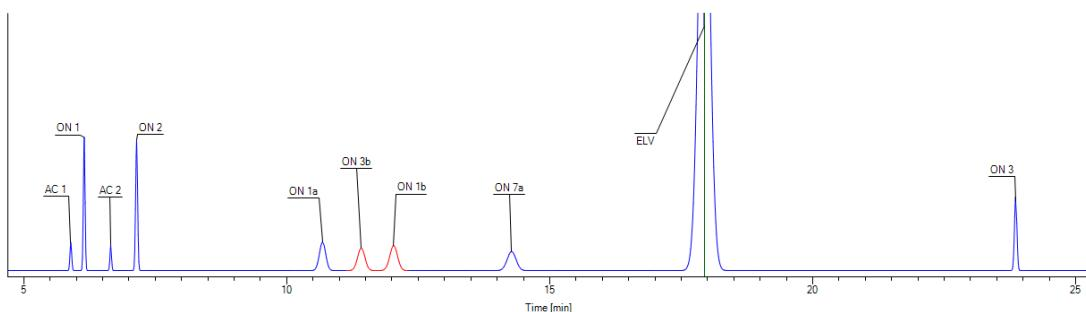
**Slika 18.** DryLab kromatogram pri uvjetima  $t = 30 \text{ min}$ ,  $T = 60^\circ\text{C}$ ,  $\text{pH} = 2,1$  i protok  $0,4 \text{ mL min}^{-1}$
