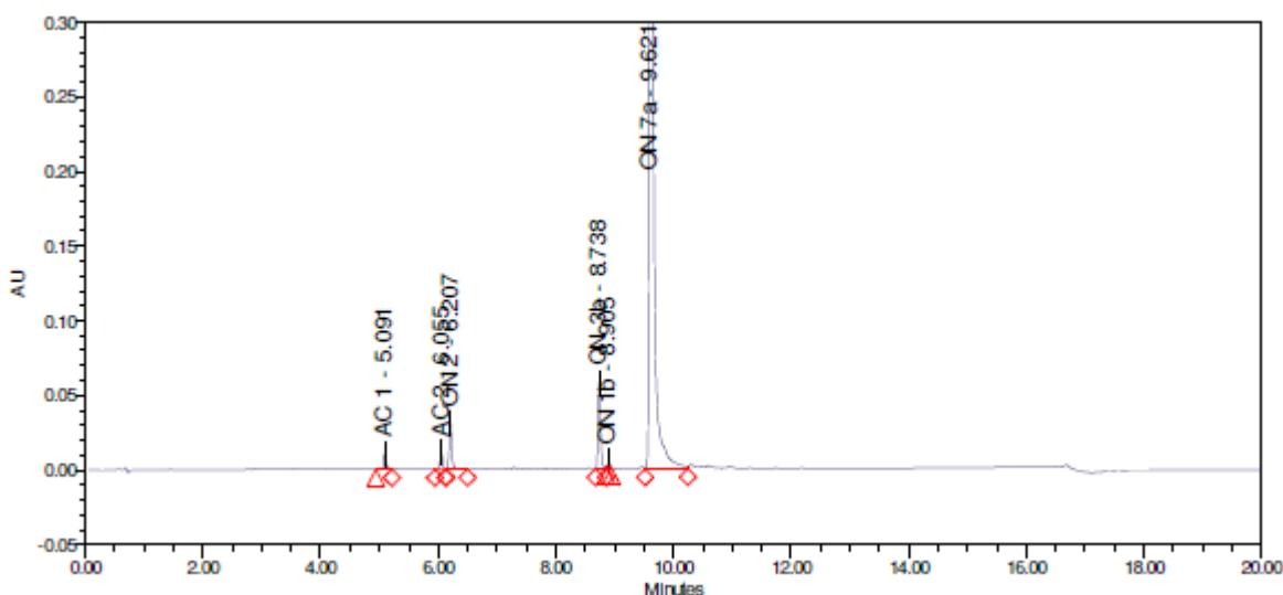
Slika D26. Kromatogram otopine IMP 1.2 pri uvjetima  $t = 15 \text{ min}$ ,  $T = 60^\circ\text{C}$  i  $\text{pH} = 6,8$
