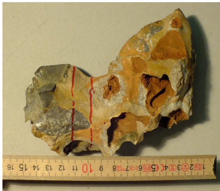
Slika 9). Uzorak pleistocenske breče iz Selina. Neke valutice su otopljene, a neke nisu.
