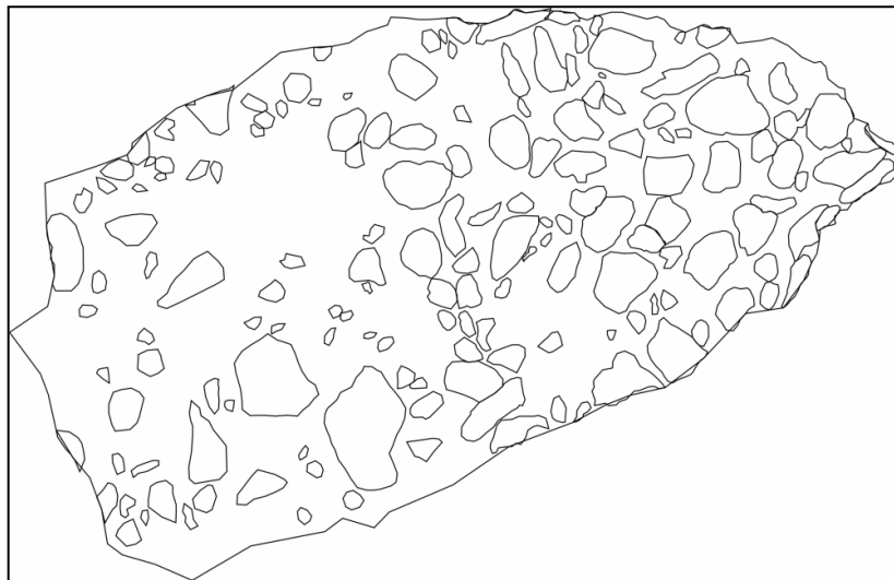
Slika 7) Crtež skeniranog uzorka 3 iz Bizeka. Šupljine su okonturene i izmjeren im je opseg po kojem je izračunata njihova površina. Površina cijelog uzorka izračunata je po njegovom opsegu.
