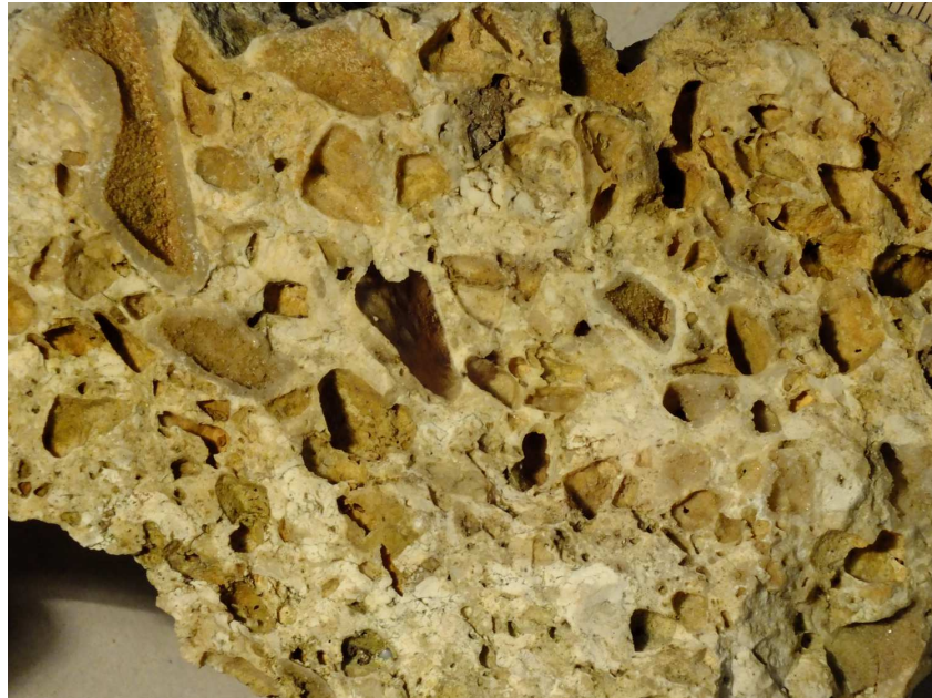
Slika 3) Stijena s velikim brojem šupljina koje su nastale otapanjem čestica stijena, litavac s Bizeka.
