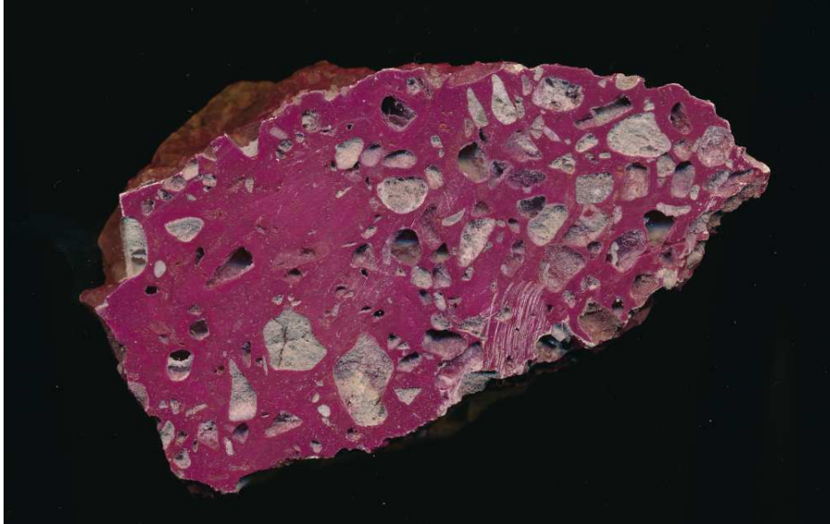
Slika 6) Obojeni uzorak 3 iz Bizeka. Vide se dolomitne valutice koje nisu obojene i ispunjene šupljine, a matriks je obojen crveno što znači da je od kalcita.
