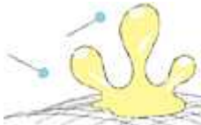
Slika 4. Raspršivanje masne mrlje u sitne kapljice (emulgacija).
