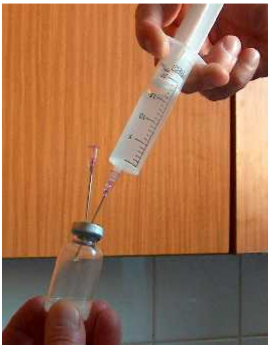
Slika 16. Punjenje fermentacijskih boica uzorkom, potrebne su 2 igle.
