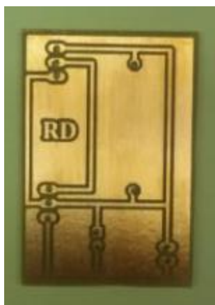
27. Izbušena pločica spremna za lemljenje
