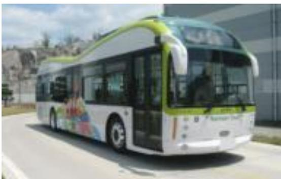
Slika 10. OLEV autobus na električni pogon
