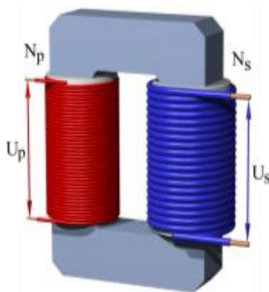
*Transformator*, najjednostavniji i najčešće korišten uređaj za bežični prijenos energije, zasniva se na međuinstrukciji. Primarna zavojnica namotaja  $N_p$ , napona  $U_p$  i sekundarna zavojnica  $N_s$ , napona  $U_s$  nisu povezane žicama, a namotane su na željeznu jezgru.
