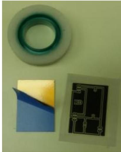
Slika 22. Lijepljenje prozirnica i priprema za osvijetljavanje
