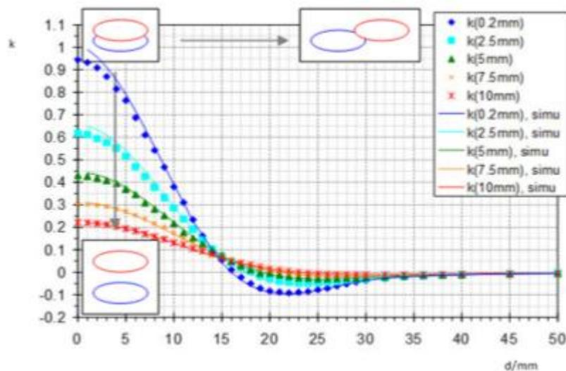
Slika 7. Ovisnost faktora sprege o udaljenosti zavojnica
