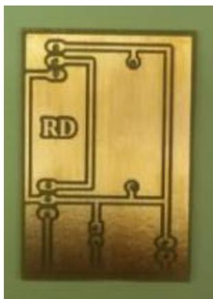
27. Izbušena pločica spremna za lemljenje
