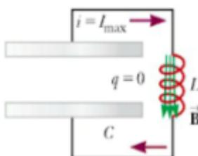
2. Zatvaranjem kruga, poteče struja od pozitivno nabijene ploče prema negativnoj i počinje pražnjenje kondenzatora težeć ravnotežnoj raspodjeli naboja.
