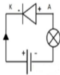
simbola diode dvije strelice). Jednostavno rečeno, uz narinuti napon priključen tako da je negativan pol izvora na katodi a pozitivan na anodi, dioda je propusno polazirana i vodi stuju, a suprotan polaritet narinutog napona dioda neće voditi.
