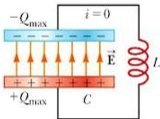
3. Inducirana struja ponovno puni kondenzator, no ovaj put sa suprotno nabijenim pločama, a električna energija se pohranjuje u polju između ploča, dok je magnetna energija  $E_m$  nula.
