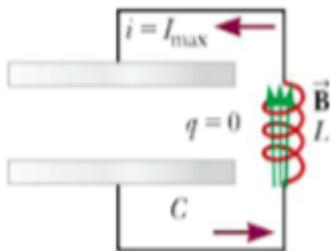
4. Struja u krugu ponovno uzrokuje promjenu magnetskog toka unutar zavojnice, inducira se naponi struja i cijeli slučaj 2. se ponavlja u suprotnom smjeru.
