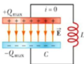
1. Kondenzator i zavojnicu spojimo u strujni krug preko prekidača  $P$  bez nekakvg vanjskog izvora. Prije zatvaranja nabijemo kondenzator količinom naboja  $Q_0$  (analgno pomicanju opruge iz ravnotežnog položaja). Struja je nula, a u kondenzatoru je pohranjena najveća energije električnog polja:
