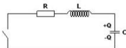
Slika 15. Jednostavan električni titrajni krug
