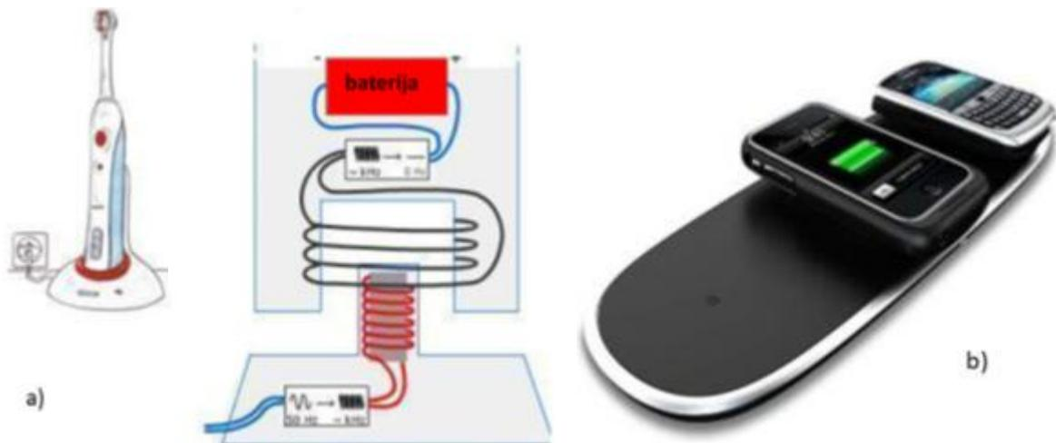
Slika 8. Primjer induktivne veze : a) kod električne četkice
