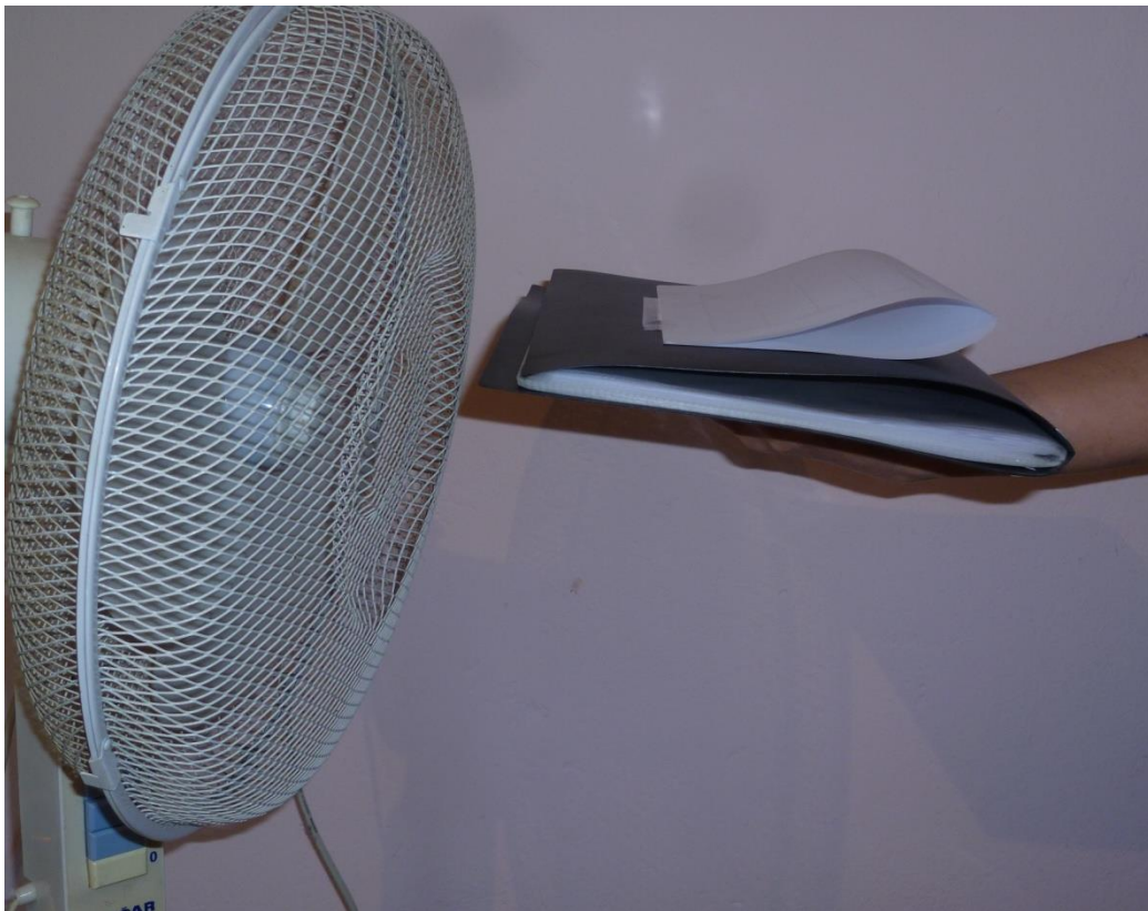
Slika 4.5. Jednostavni model avionskog krila
