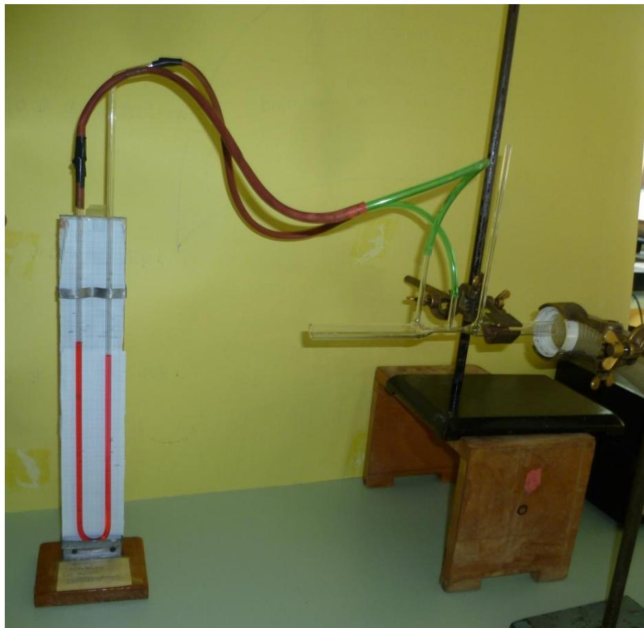
Slika 4.8. Venturijeva cijev
