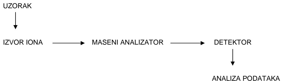
**Slika 7. Shematski prikaz masenog spektrometra**
