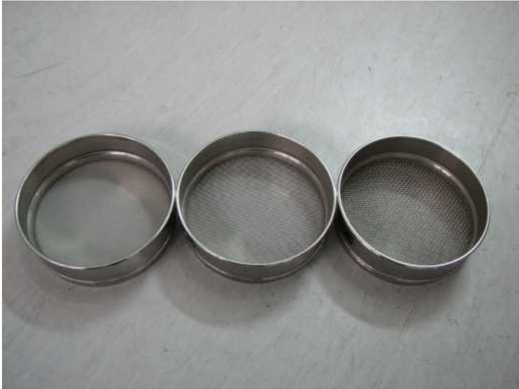
Slika 17. Sita veli ine mreža od 2.5, 1.0 i 0.315 mm za odvajanje pojedinih frakcija uzoraka
