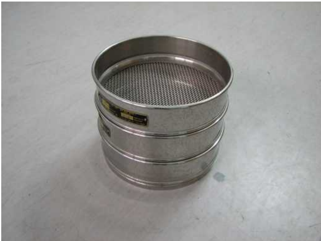
Slika 18. Sita postavljena jedno na drugo kako se koriste pri ispiranju uzoraka
