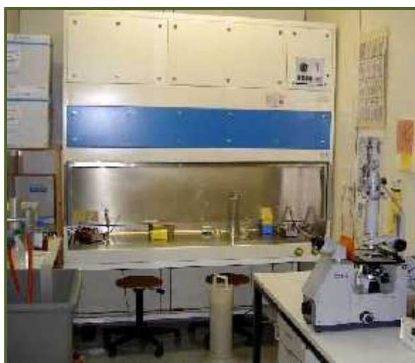
Slika 3. Komora sa sterilnim protokom zraka (laminar) u kojem se sterilno biljno tkivo uvodi u kulturu in vitro .
