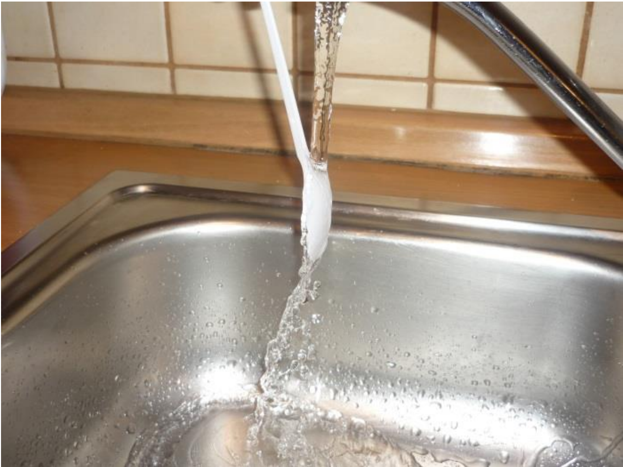
Slika 4.30. Žlica se prilijepila uz mlaz vode
