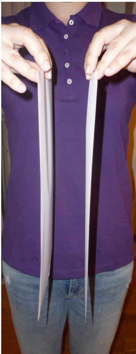
Slika 4.26. Listovi papira između kojih nema strujanja zraka
