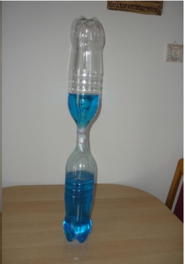
Slika 4.33. Izvedba pokusa „Tornado u boci“
