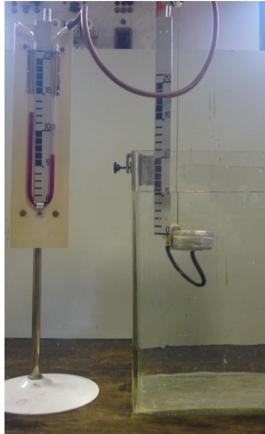
Slika 4.15. Pomičan stalak uronjen na određenu dubinu u vodi
