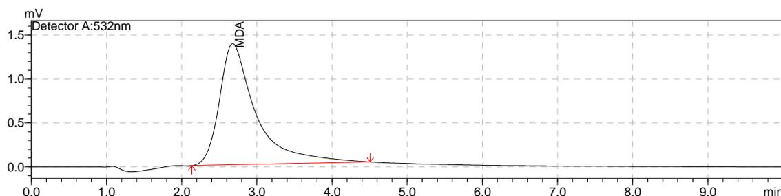
**Slika 11 Kromatogram standarda MDA koncentracije 1,518  $\mu\text{M}$**
