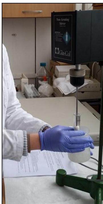
Slika 8. Homogeniziranje tkiva u staklenoj epruveti homogenizatorom s teflonskim batićem (snimila izv. prof. dr. sc. Jasna Lajtner).
