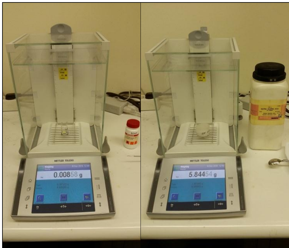
Slika 11. Vaganje DTNB i NaCl za pripremu svježe otopine prije analize.
