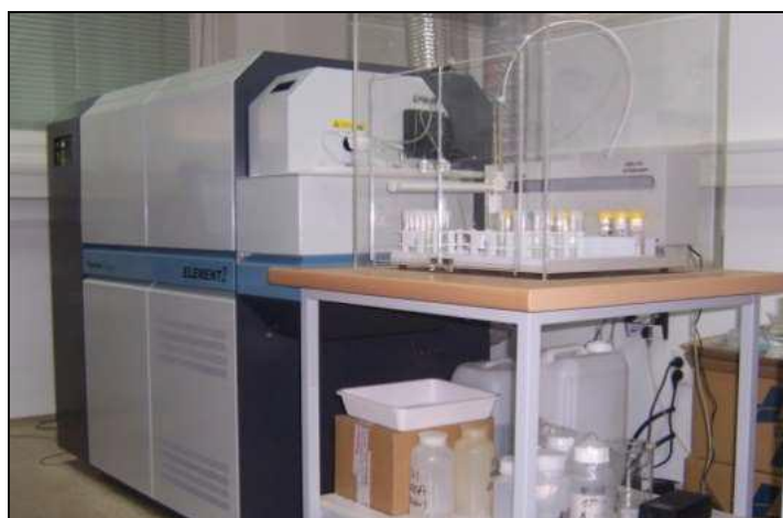
Slika 9. Maseni spektrometar visokog razlučivanja s induktivno spregnutom plazmom (HR ICP-MS) (snimila dr. sc. Vlatka Filipović Marijić).
