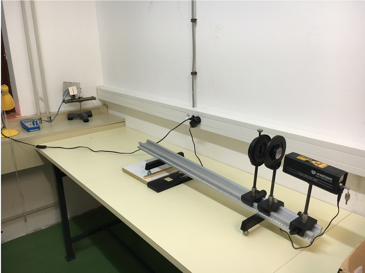
Slika 4.7: Prikaz eksperimentalnog postava vježbe Ogib svjetlosti
