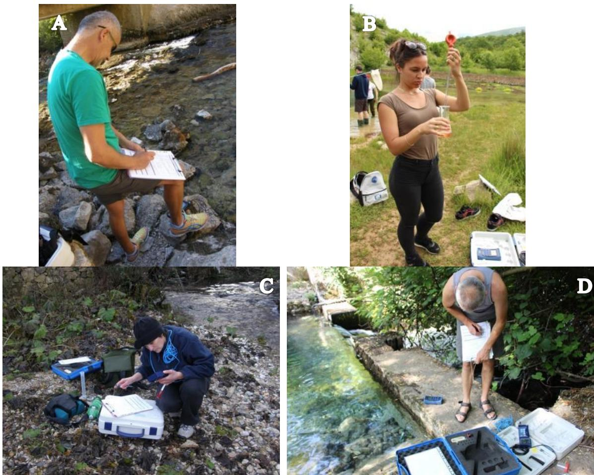
**Slika 8.** Prikaz metodologije prikupljanja podataka i mjerjenja fizikalno-kemijskih parametara vode: A – ispunjavanje terenskog formulara; B – titriranje vode kloridnom kiselinom tijekom određivanja količine kalcij-karbonata u vodi; C - higrometrijsko krilo za mjerjenje brzine strujanja vode; C – mjerjenje pH, količine otopljenog kisika u vodi i električne provodnosti vode WTW sondama.
