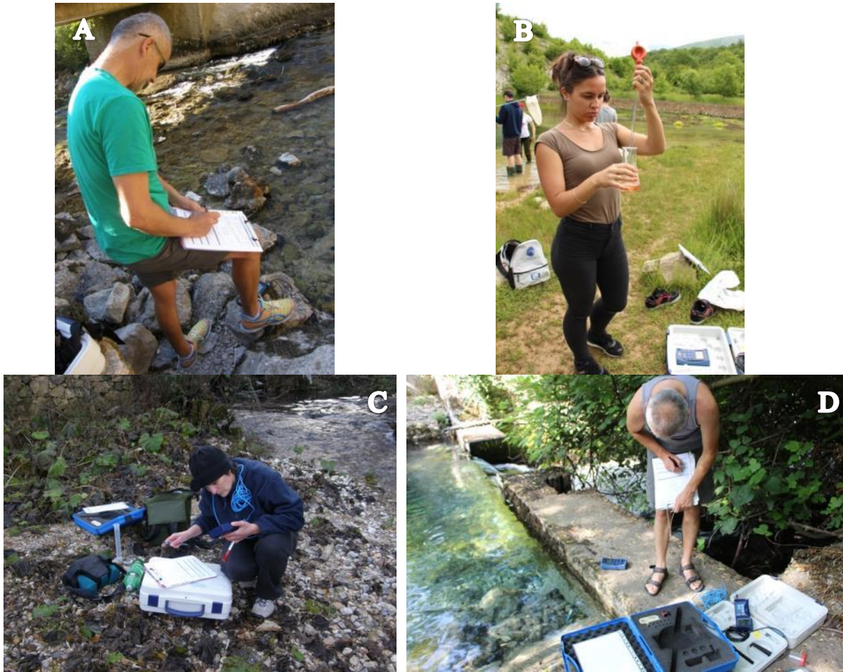
Slika 8. Prikaz metodologije prikupljanja podataka i mjerenja fizikalno-kemijskih parametara vode: A – ispunjavanje terenskog formulara; B – titriranje vode kloridnom kiselinom tijekom određivanja količine kalcij-karbonata u vodi; C - higrometrijsko krilo za mjerenje brzine strujanja vode; C – mjerenje pH, količine otopljenog kisika u vodi i električne provodnosti vode WTW sondama.
