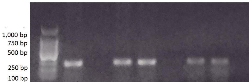
Slika 7. Elektroforeza u 1%-tnom agaroznom gelu (dobivene vrpce pokazuju uspješno umnožene lokuse DRB duljine oko 300 pb za neke od uzoraka)
