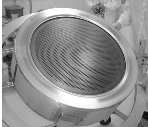
Slika 4.4: Ionski motor s promjerom akceleracijske rešetke od 57\text{cm} [8]
