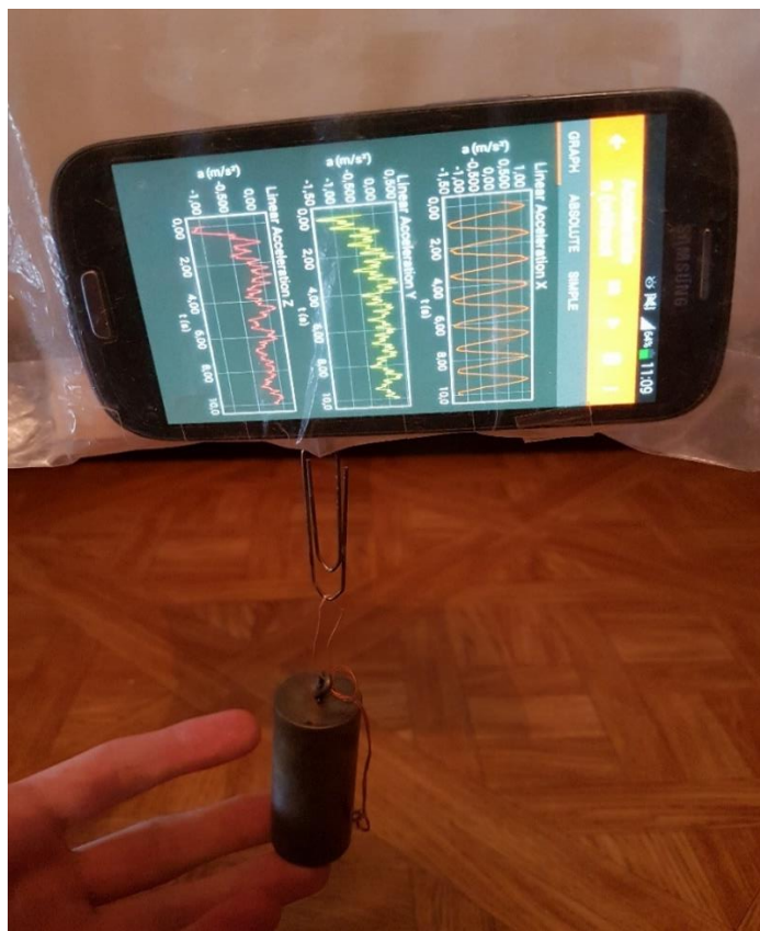
Slika 19: Ekran mobitela pokazuje slobodno titranje utega u intervalu od 10s.
